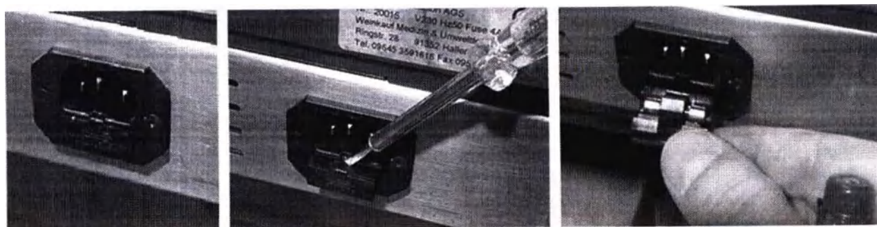
Рисунок 8.1 – Замена предохранителя (розетка подключения кабелей питания в блоках модулей станции заливки AGS)
