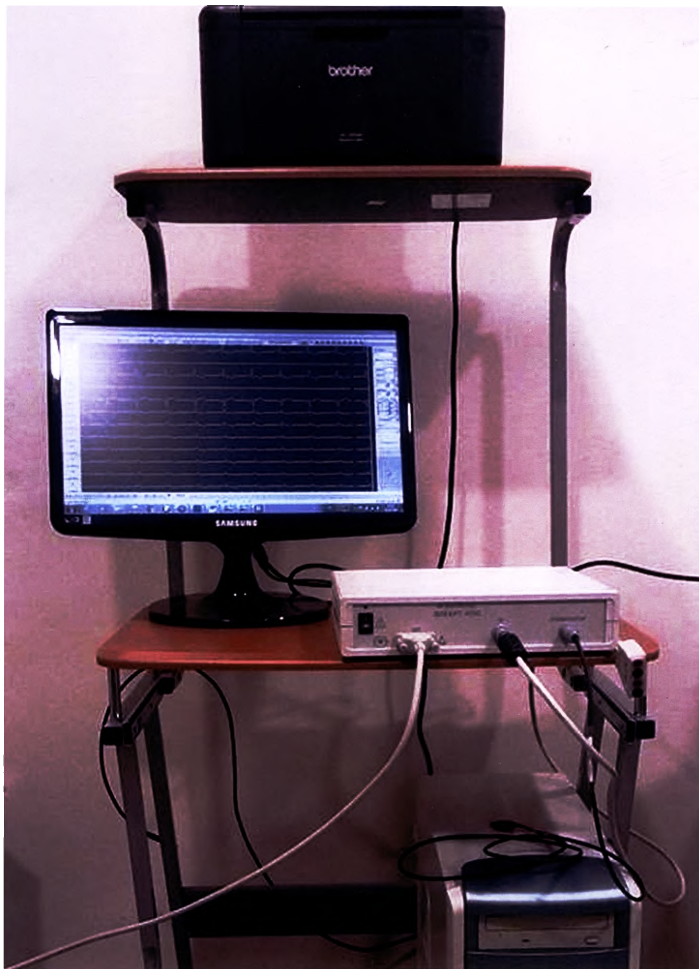
Фотографическое изображение комплекса для проведения электрофизиологических исследований сердца в исполнении "ЭЛКАРТ-ЧПС"
