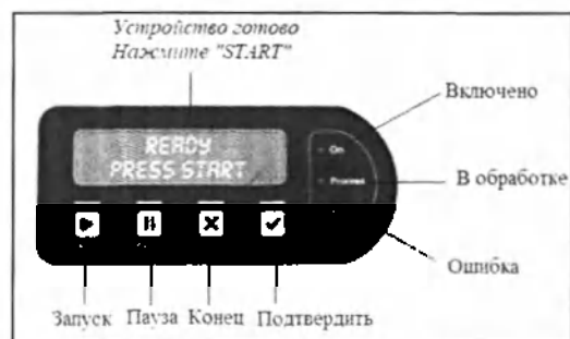
Рис. 3. Вид клавиатуры и дисплея блока управления
