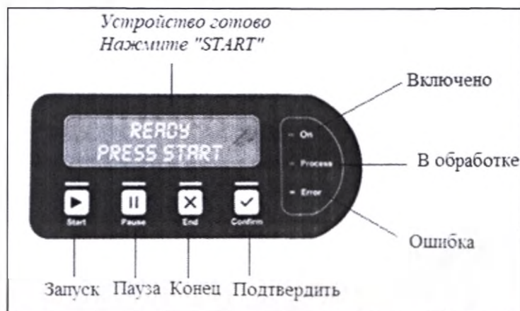
Рис. 14. Дисплей и клавиатура блока управления GS 1000
