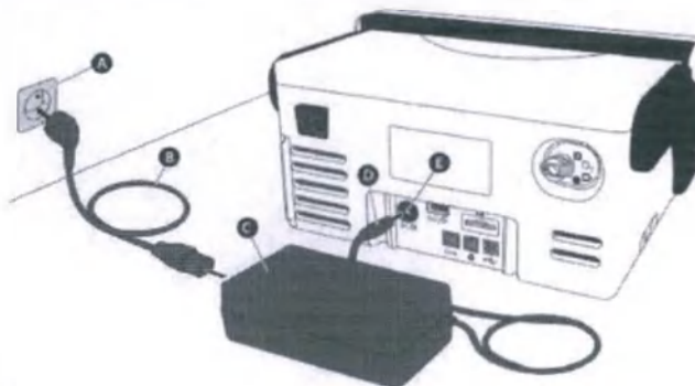
Рис.: Подключение к сети через блок питания
