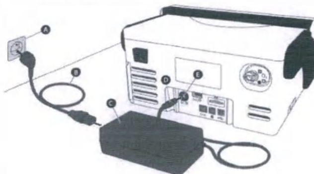
Рис.: Подключение к сети через блок питания
