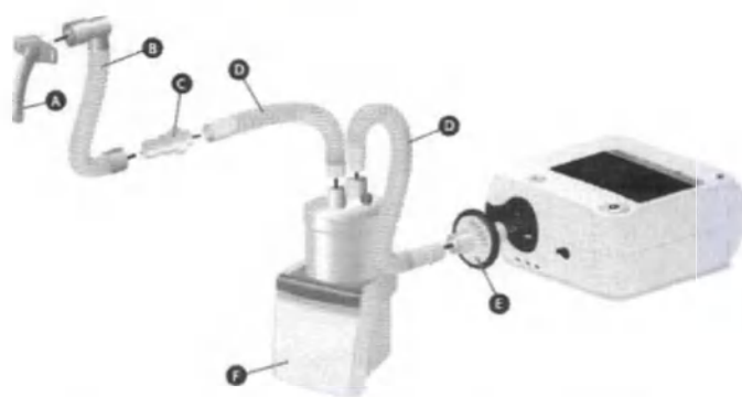
Рис.: Установка системы, инвазивная вентиляция с внешним увлажнением воздуха
