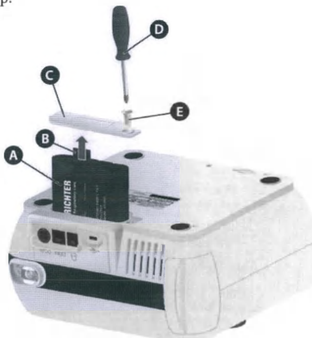
Рис.: замена батареи
