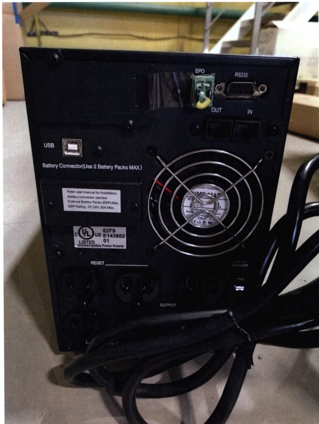
Источник бесперебойного питания: вид сзади
