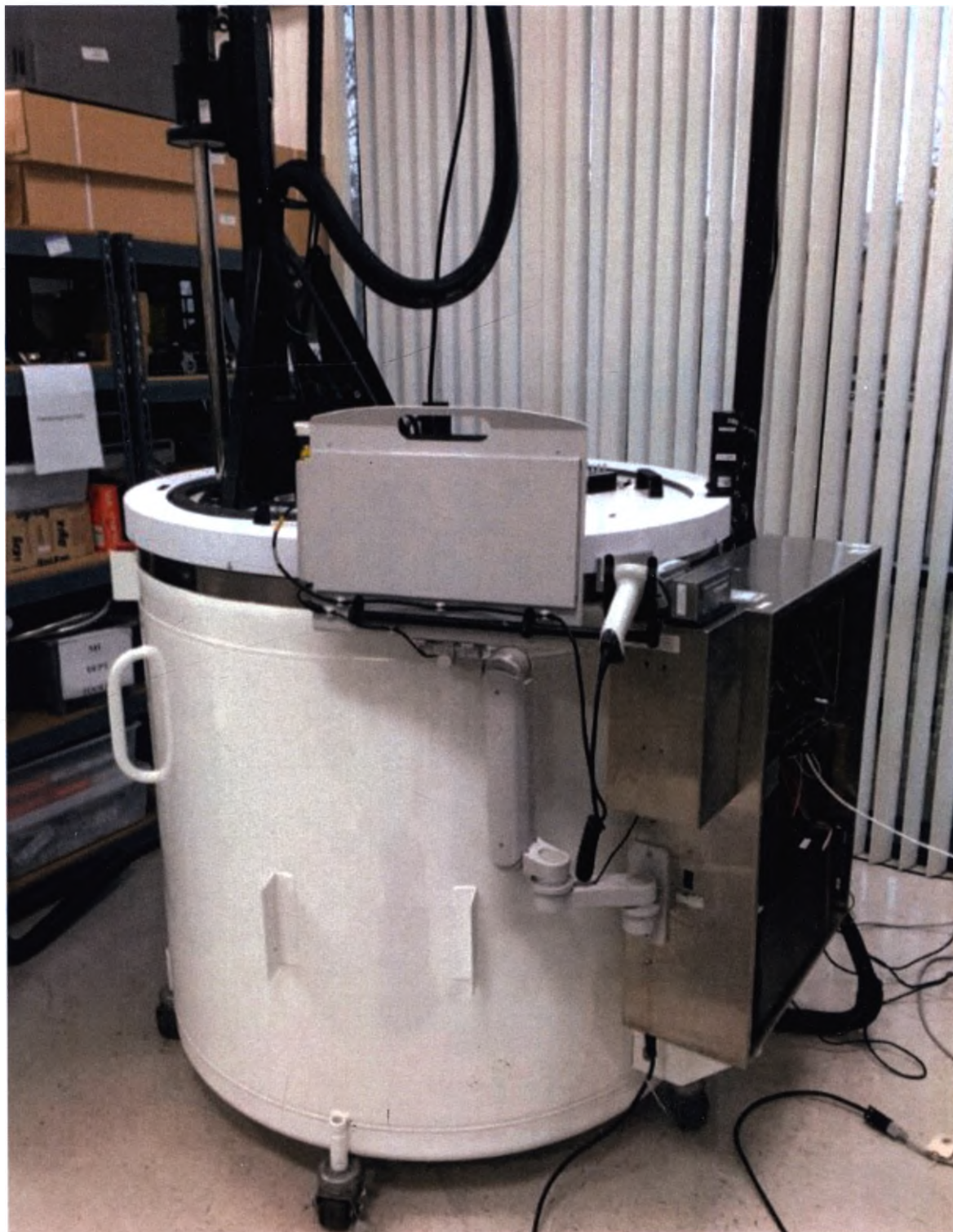
Сосуд дьюара со стойками хранилища для заполнения жидким азотом: общий вид
