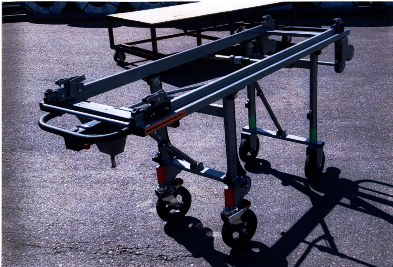
Рис.4.3. Комплект средств размещения-перемещения пациентов для применения в службе скорой медицинской помощи и госпитальной транспортировки по ТУ 30.99.10-016-47272295-2021 (тележка –каталка).
