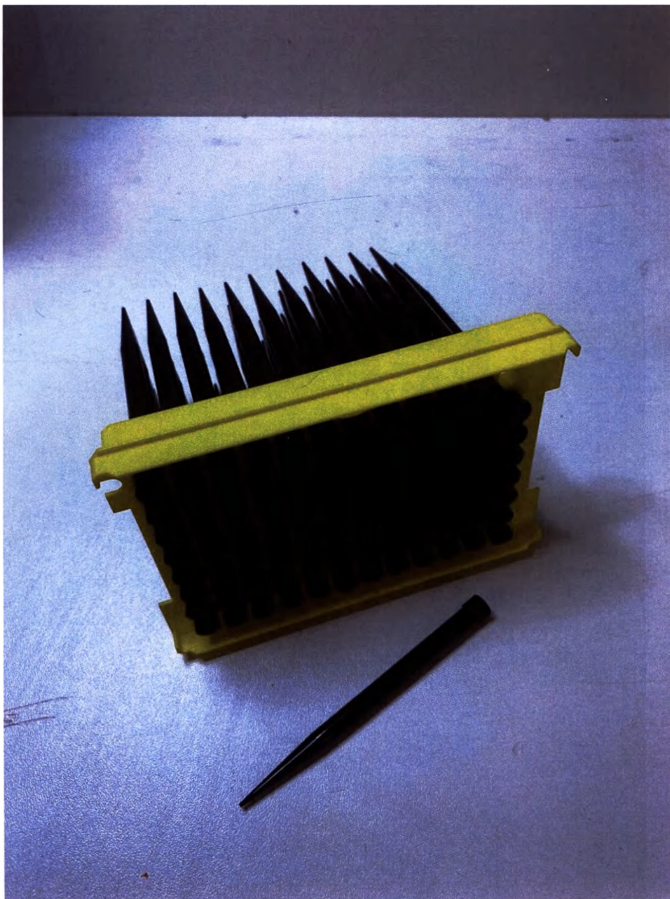
Рисунок 8. Наконечники для переноса жидкости одноразовые, 192 шт.
