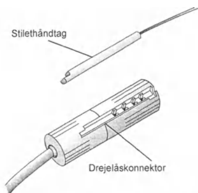
Figur 1. Indsæt stilethåndtaget i drejelåskonnectoren.
