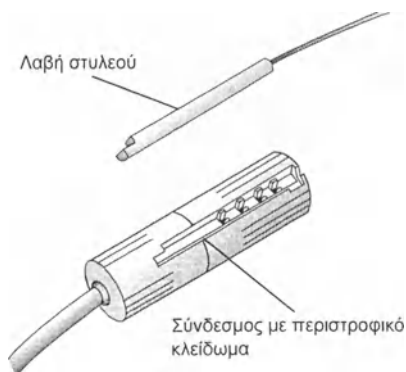
Εικ. 1. Εισαγάγετε τη λαβή του στυλεού μέσα στο σύνδεσμο με περιστροφικό κλειδώμα.
