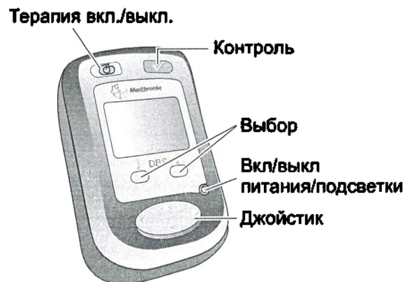
Рис. 2.2 Кнопки, используемые для управления пультом пациента
