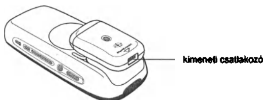
2. ábra. Az orvosi programozóhoz csatlakoztatott külső neurostimulátor
