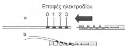
Εικ. 7. Προσαρτήστε το βραχύ στυλεό στο ηλεκτρόδιο.
