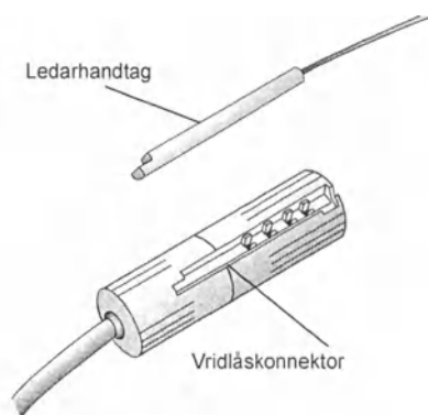
Figur 1. För in ledarhandtaget i vridlåskonnektorn.
