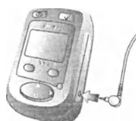
Рис. 2.24 Подсоединение штекера антенны к антенному гнезду
