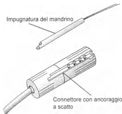
Figura 1. Inserimento dell'impugnatura del mandrino nel connettore con ancoraggio a scatto.
