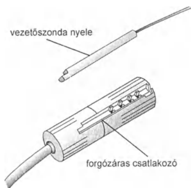
1. ábra. Helyezze a vezetősonda nyelét a forgózáras csatlakozóba
