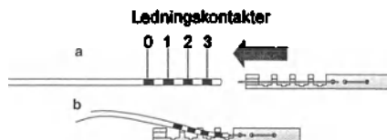
Figur 7. Feste den korte mandrengen til ledningen.
