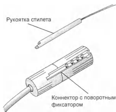
Рис. 1. Введите рукоятку стилета в коннектор с поворотным фиксатором.
