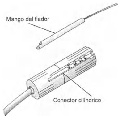
Figura 1. Introduzca el mango del fiador en el conector cilíndrico.
