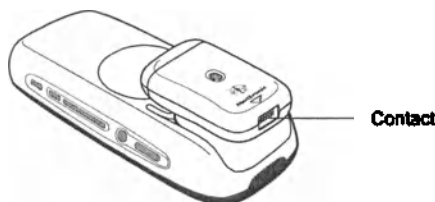
Afbeelding 2. Externe neurostimulator aangesloten op het artsprogrammeerapparaat
