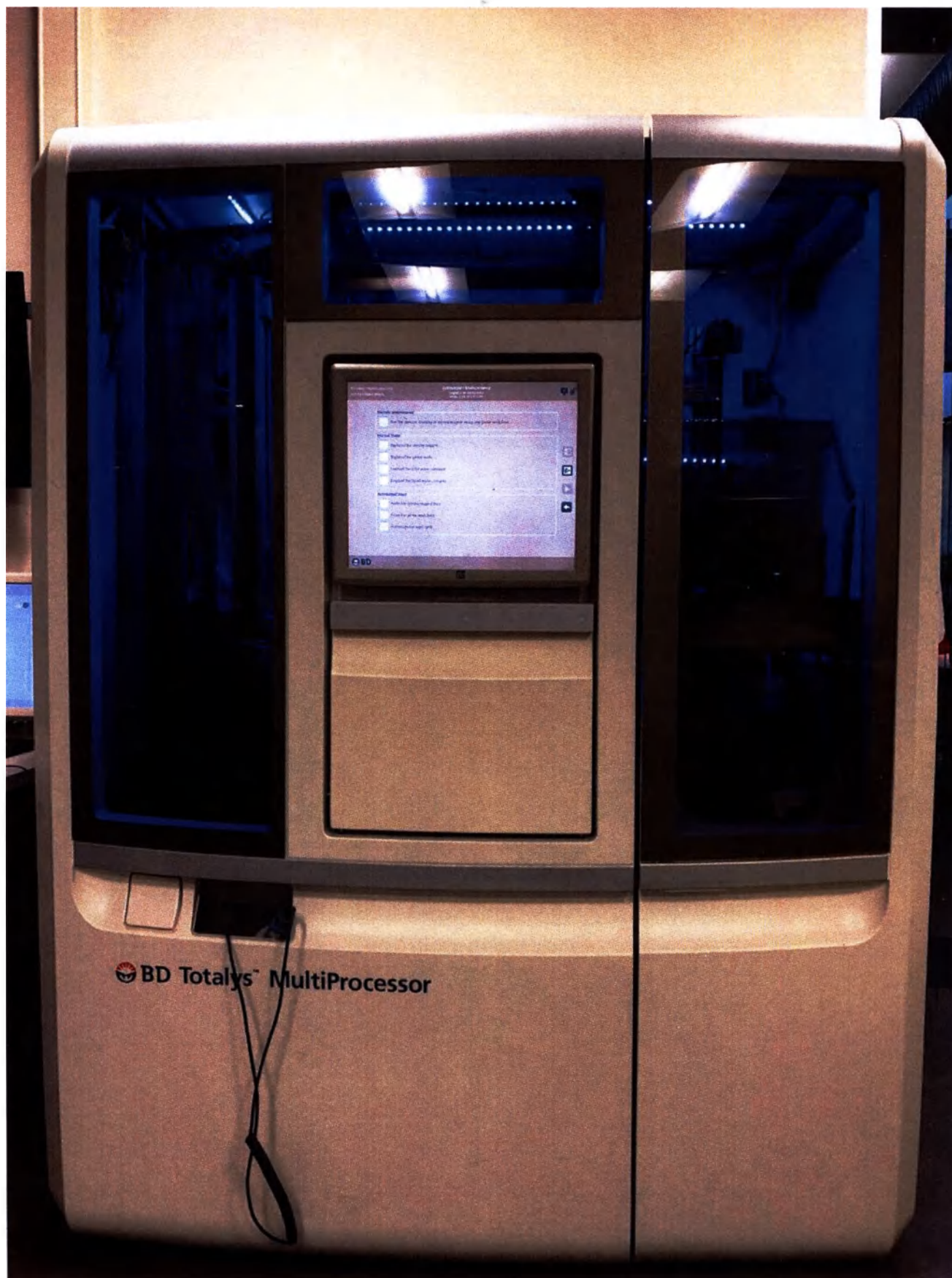
Рисунок 1. Прибор для автоматизации пробоподготовки при проведении цитологических исследований BD Totalys MultiProcessor
