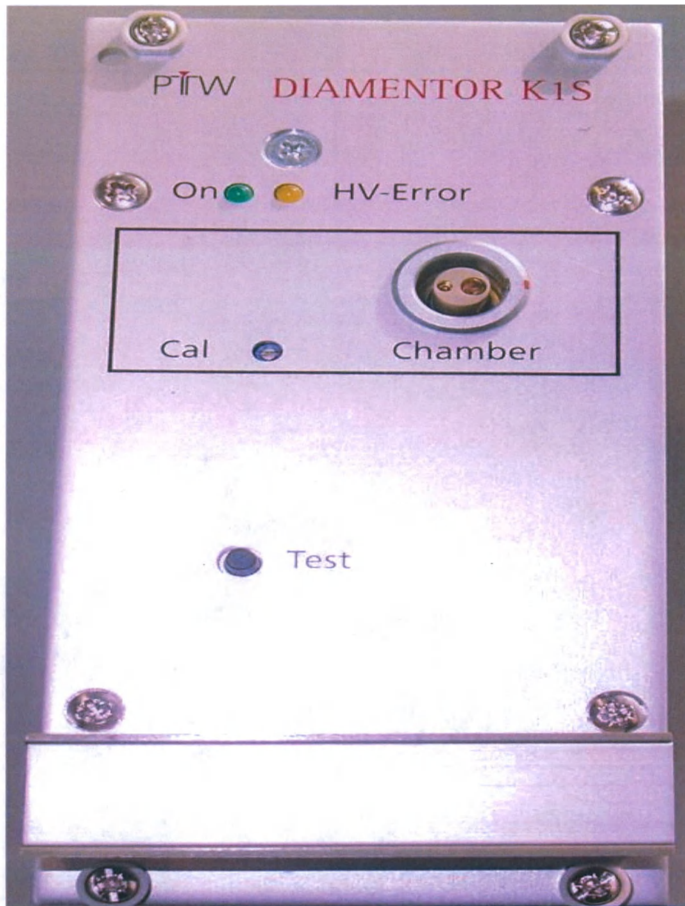
16.1. Камера для измерения дозы DIAMENTOR K1S.
