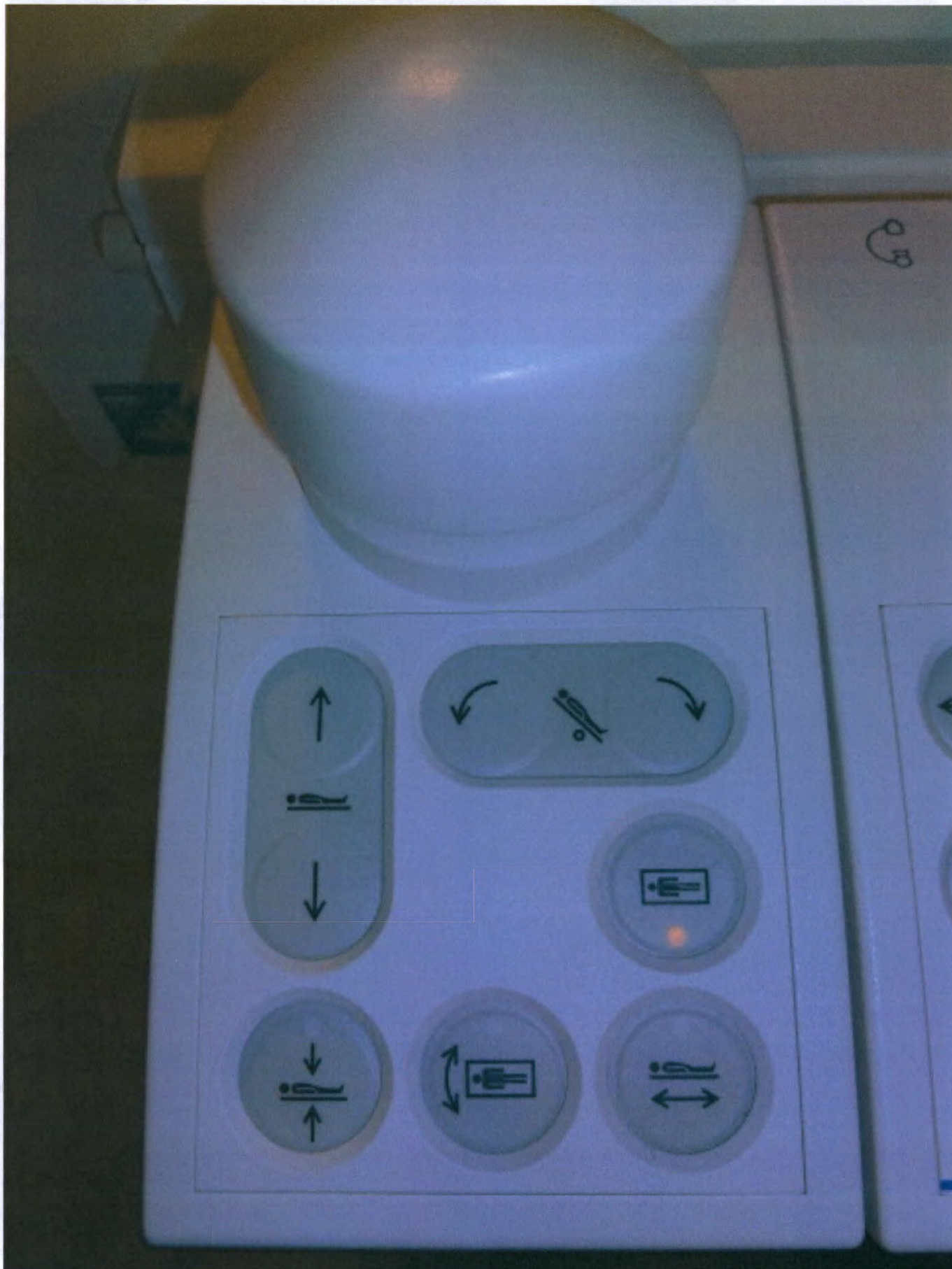
73. Модуль управления столом дополнительный в пультовой.
