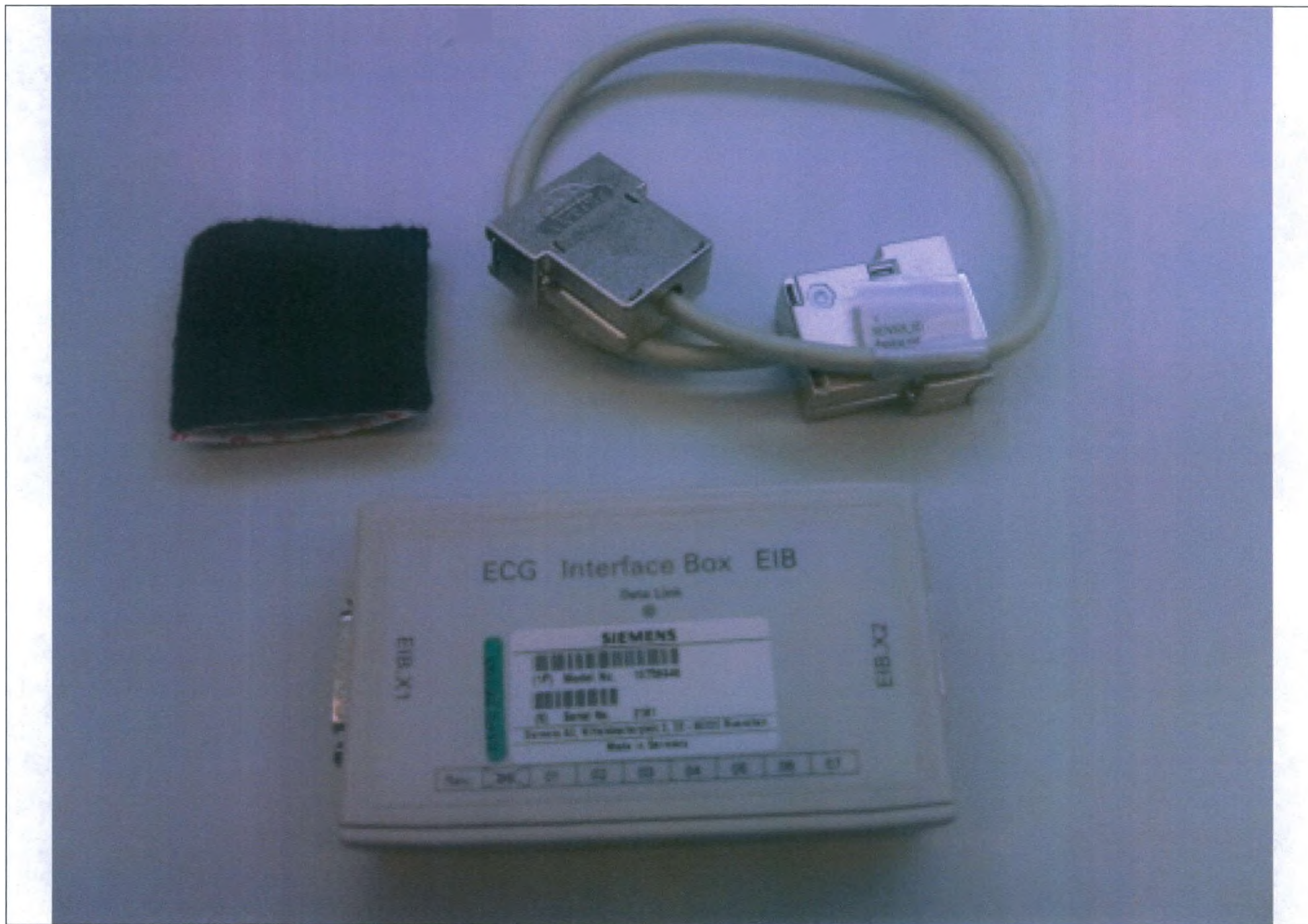
31.2. Комплект подключения системы Sensis: интерфейс; Кабели; Кабель-адаптер; Блок подключения ЭКГ. Общий вид.
