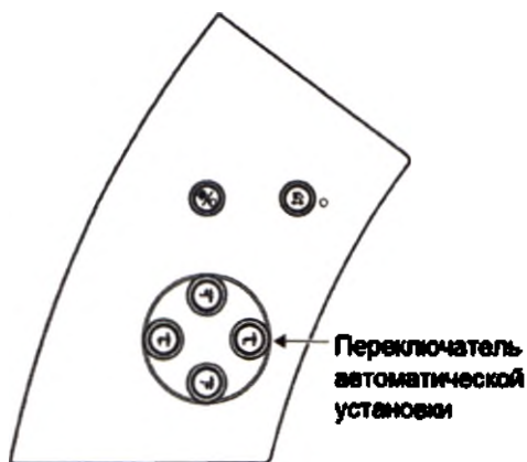
Панель управления с левой стороны гентри
