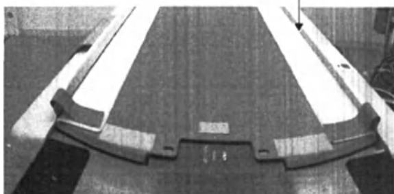
Застёжки-«липучки» для закрепления матраса на столе
