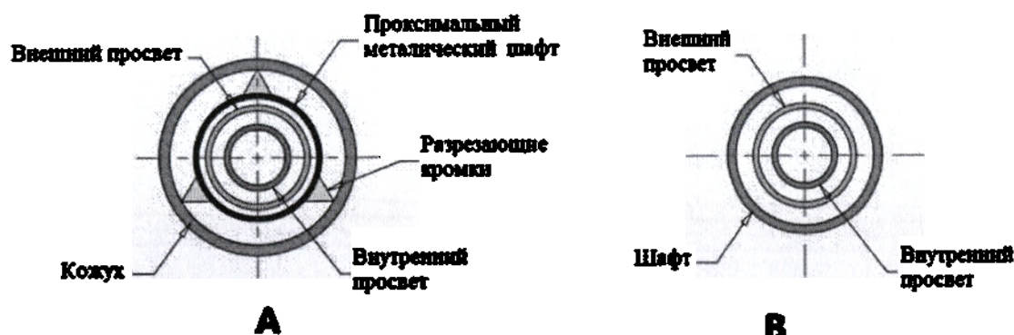
Рисунок 7.2c Катетер баллонный дилатационный периферический в варианте исполнения Tri-Wedge PTA Scoring. Конструкция изделия
