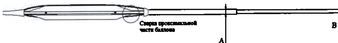
Рисунок 7.2b Катетер баллонный дилатационный периферический в варианте исполнения Tri-Wedge PTA Scoring. Конструкция изделия
