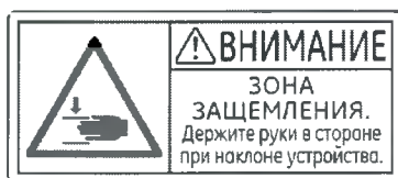
Рисунок 2-26: Предупредительная этикетка на всех четырех углах гентри
