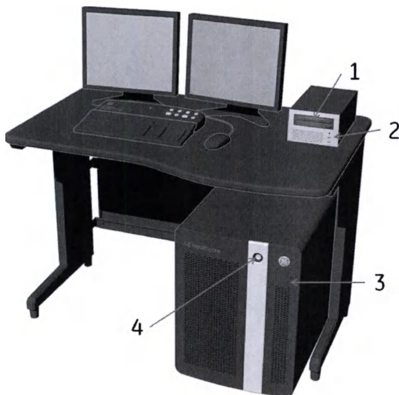
Рис. 7-5: Привод DVD-R/W (1), USB (2), соединения iLinq (3) и выключатель питания (4)
