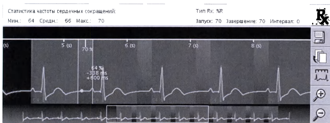
Рис. 11-53: Окно кардиальной ретроспективной реконструкции: синий цвет - окно реконструкции, серый цвет - заполнение
