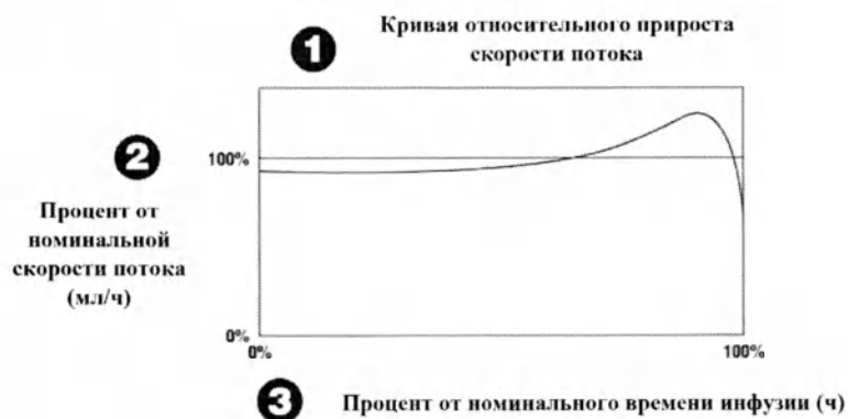
Изображение 1 - График "Типичный профиль инфузии помпы Infusor с болюсом, 5-7-12 (Вариант исполнения № 1)"
