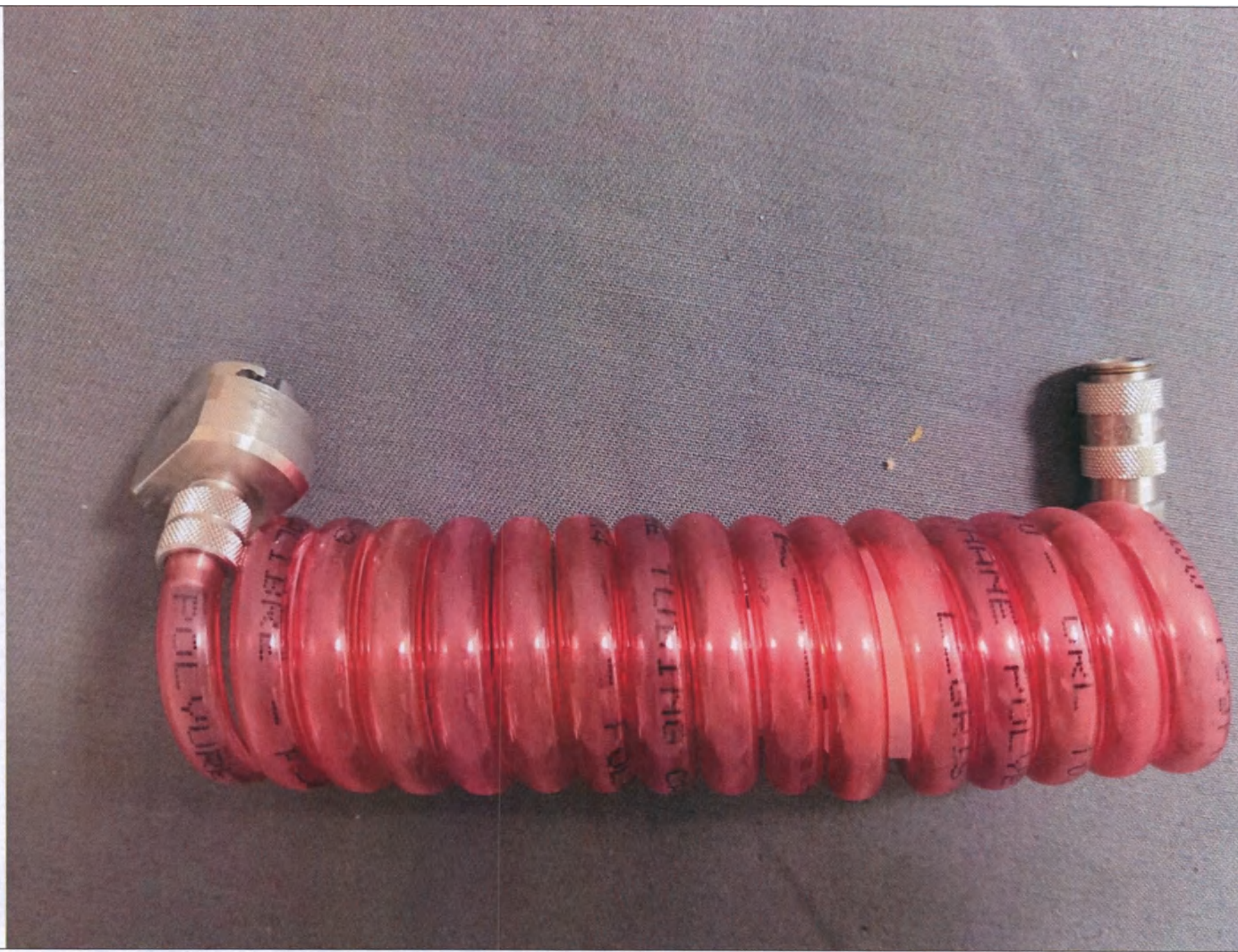
Рис. 62. Переходник для проверки герметичности для чистящих и дезинфекционных машин Belimed (11301BM)
