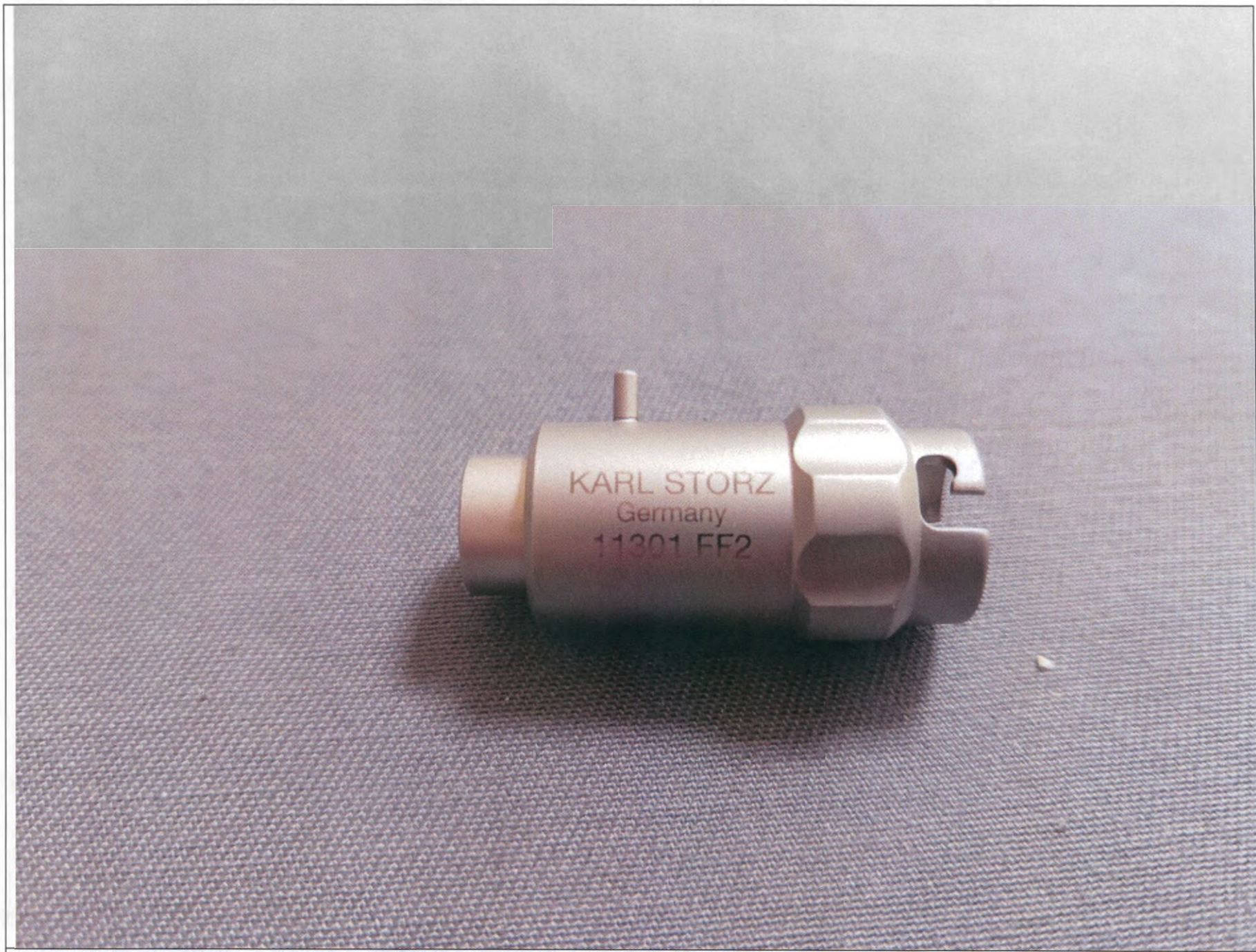
Рис. 65. Переходник для моечно-дезинфекционных машин MIELLE (11301FF2).
