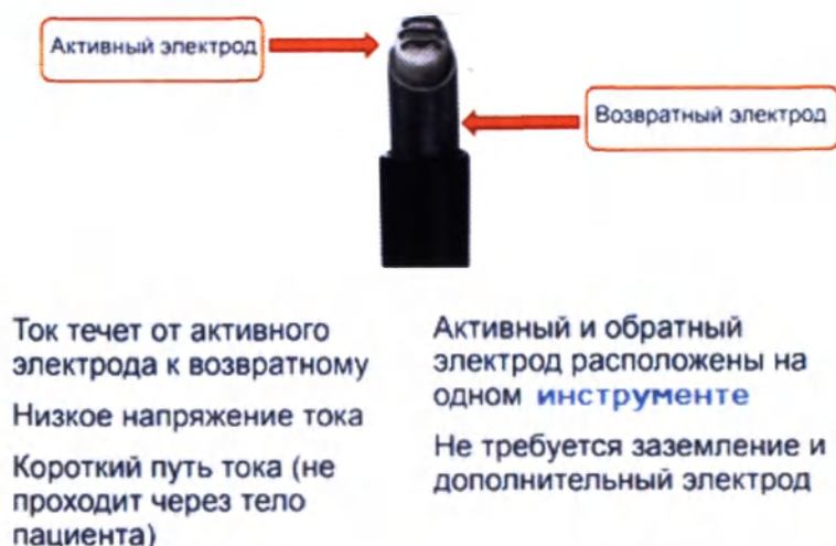
Рис. 1. Схема рабочей головки инструмента.
