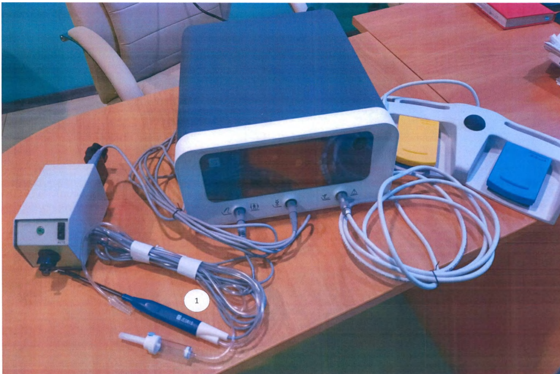
Фото 29. Инструмент (1), подключенный к Аппарату хирургический RFS-100A радиочастотной плазменной абляции и коагуляции:
