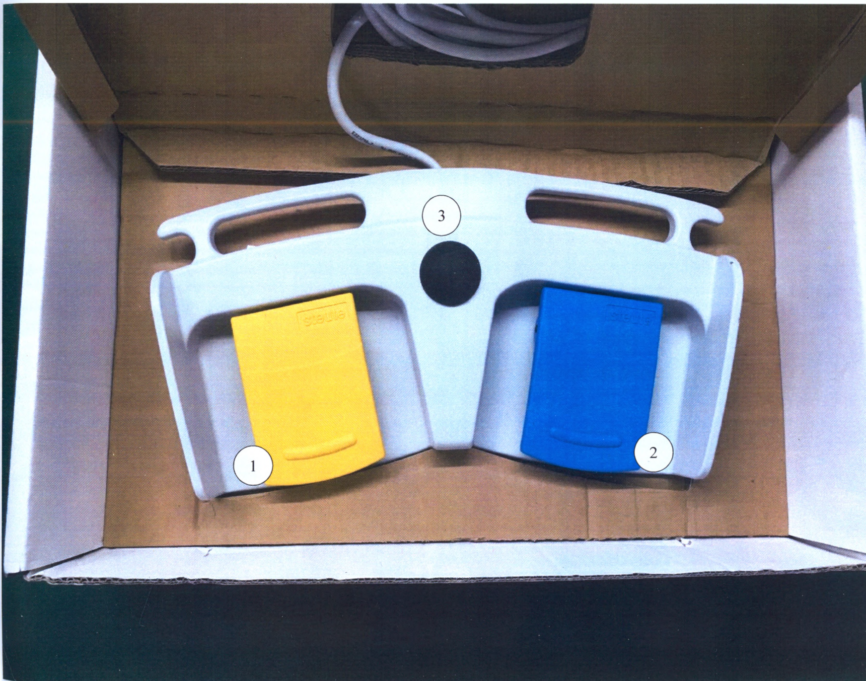
Фото 5. Переключатель ножной педальный: 1 – педаль абляции, 2 – педаль коагуляции, 3 – кнопка режима усиленной абляции.
