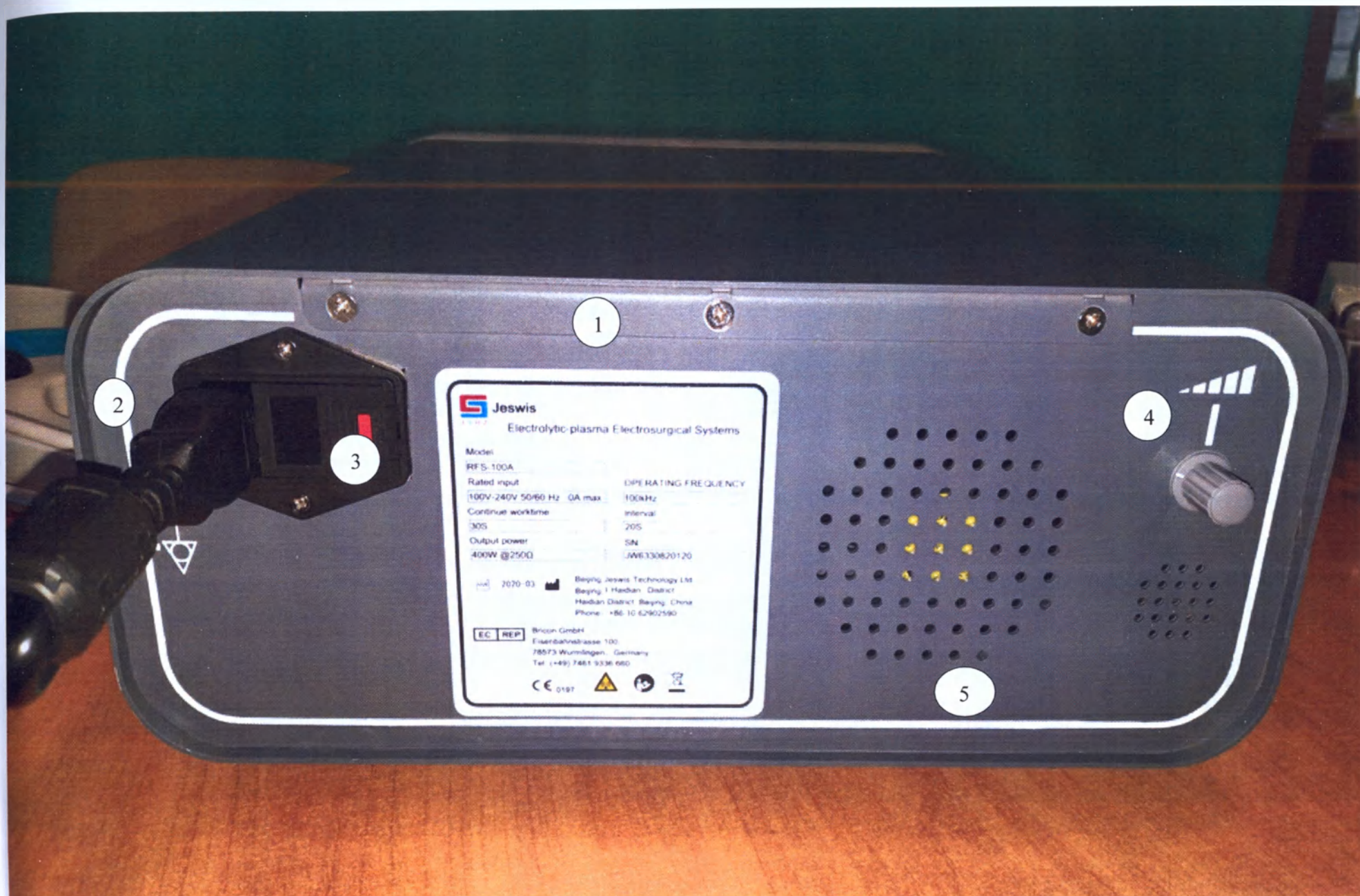
Фото 7. Задняя панель Генератора RFS-100A: 1 – Заводская табличка генератора, 2. Шнур питания, подключенный в порт генератора, 3 – Держатель предохранителя, 4. Регулятор громкости сигналов. 5- Вентиляционные отверстия.
