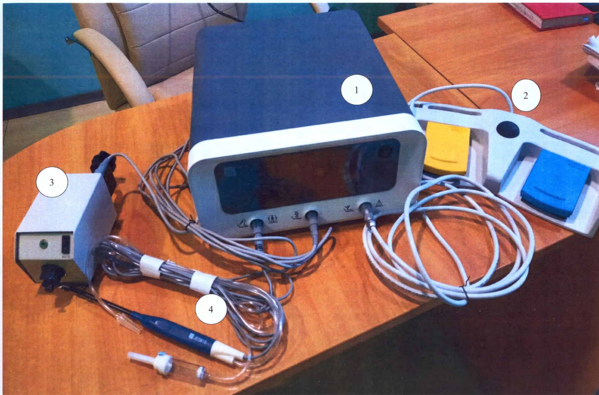
Фото 1. Аппарат хирургический RFS-100A радиочастотной плазменной абляции и коагуляции: 1. Генератор RFS-100A; 2. Переключатель ножной педальный; 3. Регулятор потока с кабелем; 5. Инструмент (не входит в комплект поставки).
