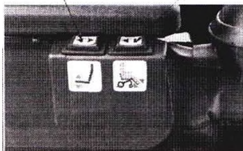
Рис. 6 – Пульт управления электроприводом сиденья (расположен с правой стороны электроколяски)
