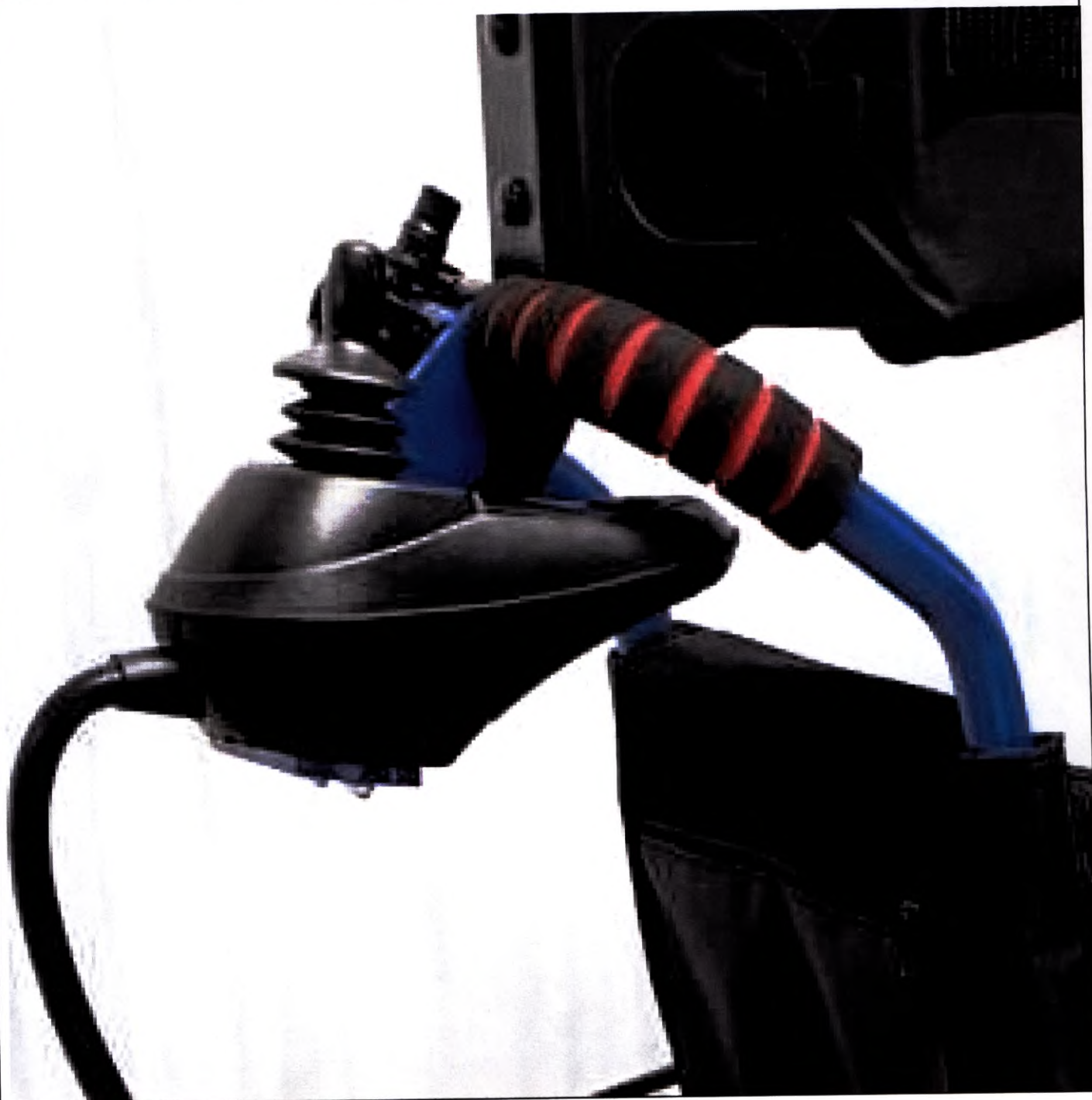
Пульт управления с расположением на спинке сидения
