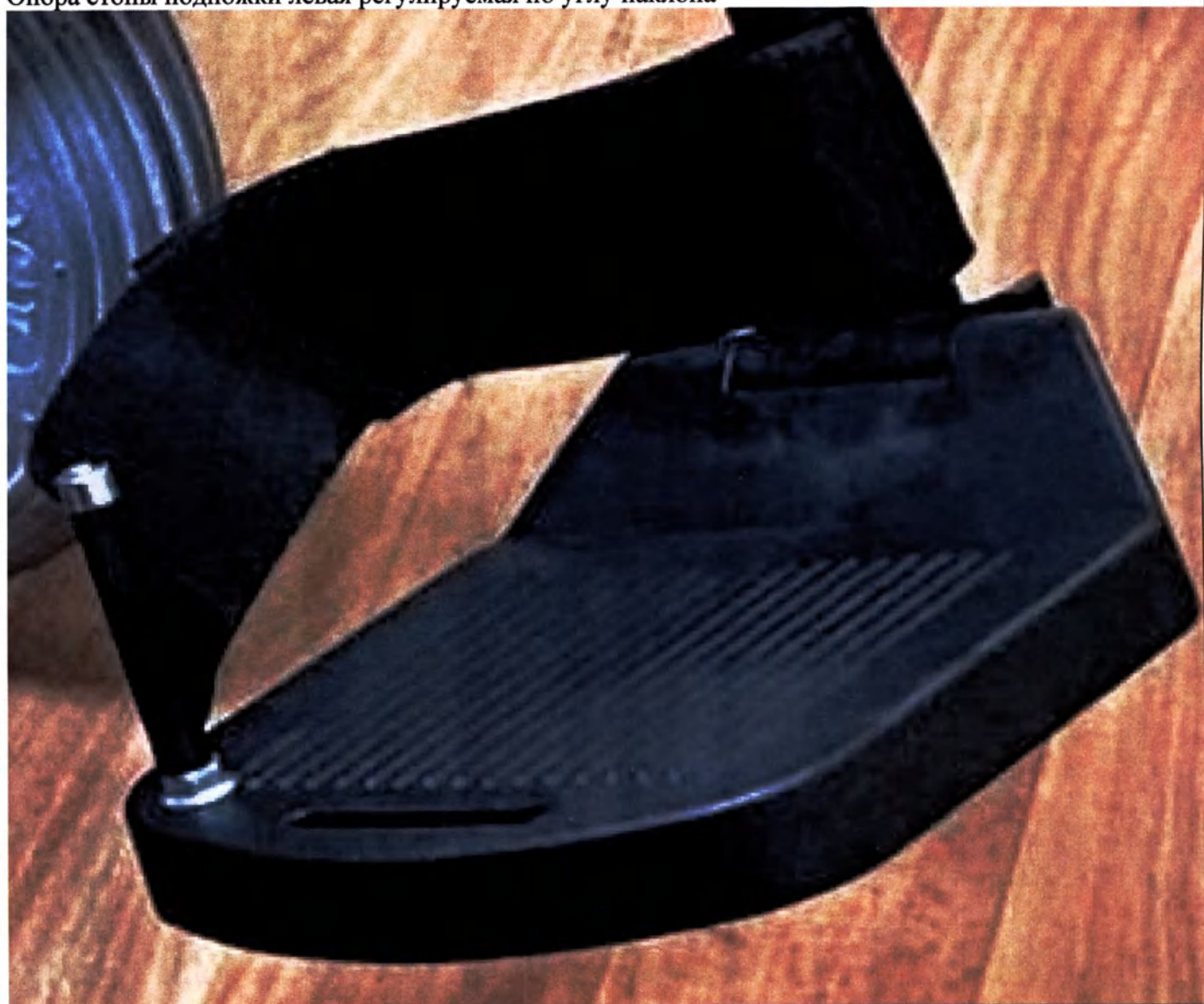
Опора стопы подножки левая регулируемая по углу наклона
