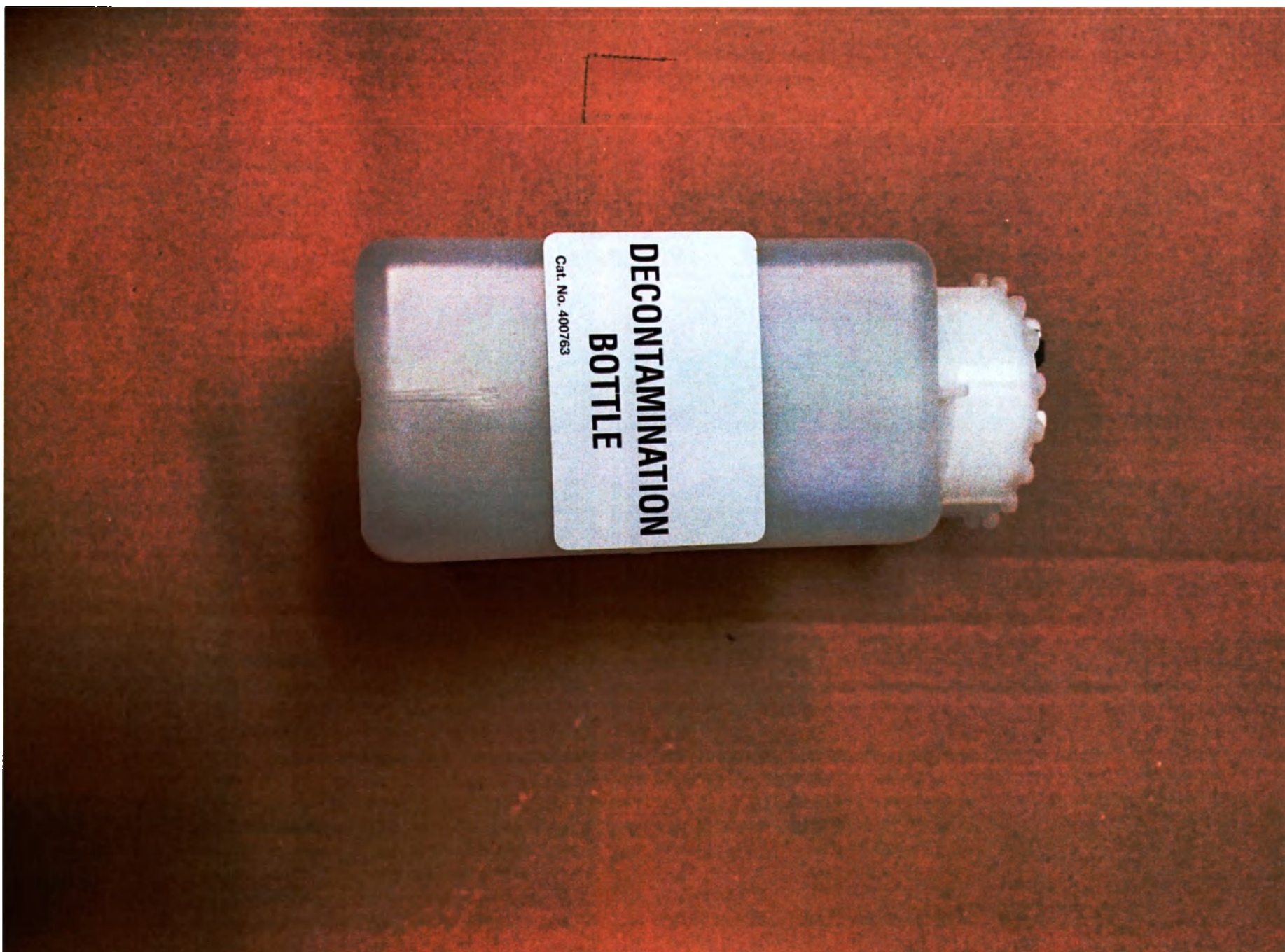
Рисунок 44. Бутыл для проведения очистки системы
