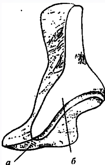
Рисунок 5. Задний жесткий берц. (вид на колодке сзади)
