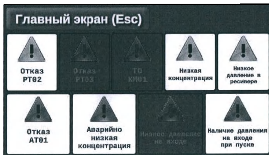
Рис. Б.2.6 Экран аварий и предупреждений.
