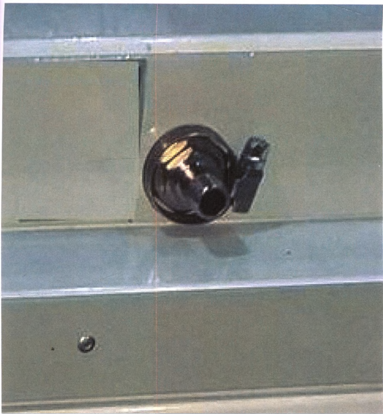
Фотографическое изображение 11 Увеличено на изображении 10. Транспортное положение, штуцера универсального, переходника-фитинга и хомута винтового. Закреплено на корпусе концентратора.
