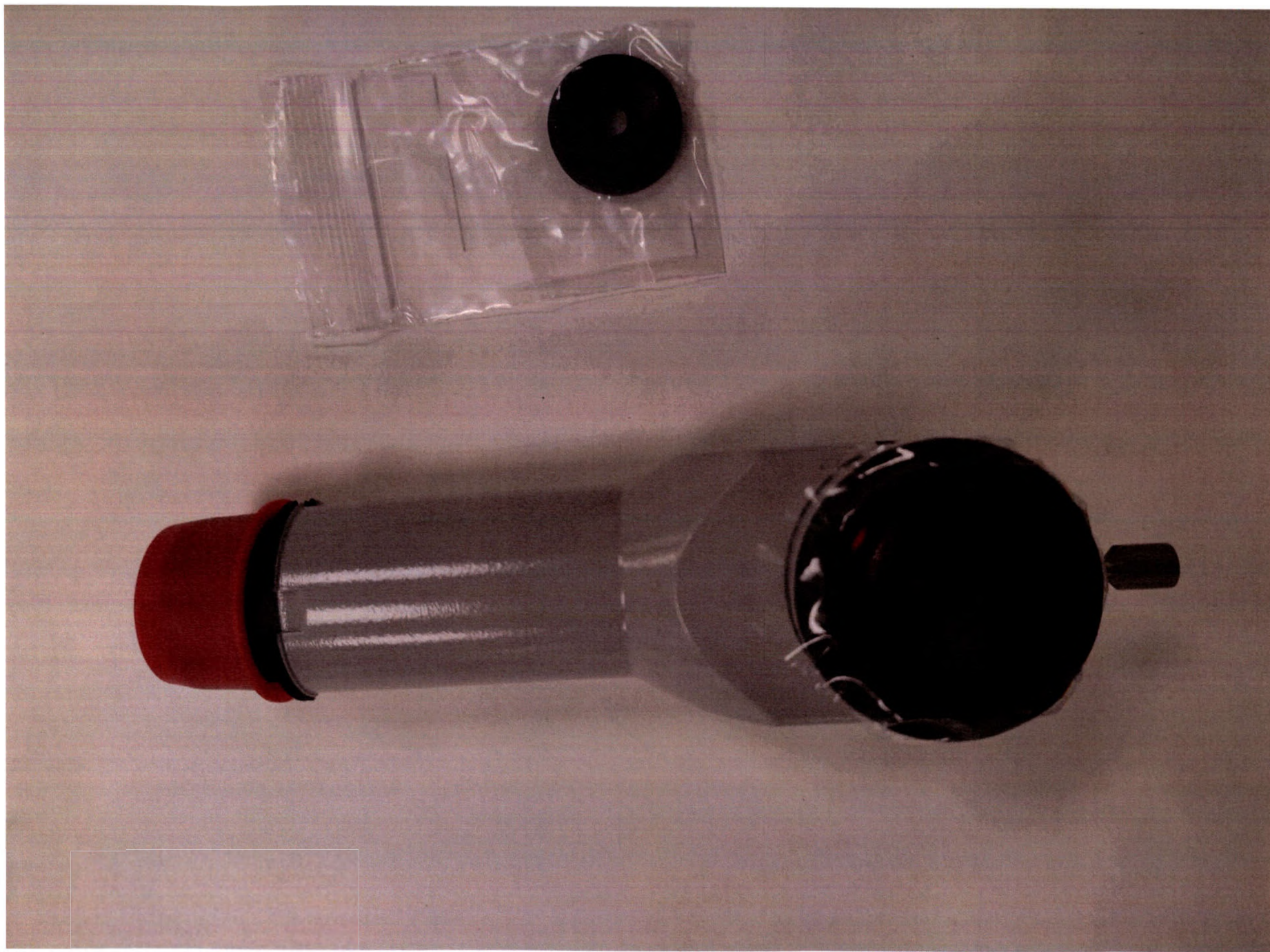
75. Фотоадаптер для камеры серии Canon EOS, f=340, T2 адаптер для камеры серии Canon EOS.
