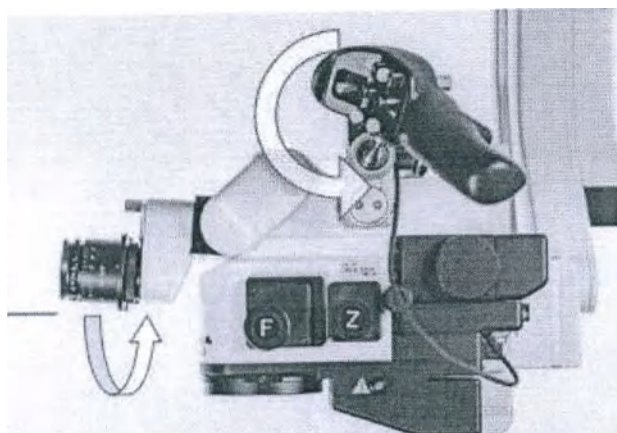
Инверсионный механизм окуляра
