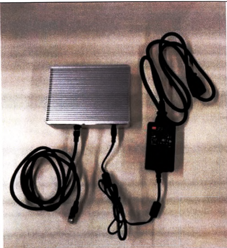
Комплект сетевого адаптера LPA11 для подключения принтера, составе: Блок LPA11; Внешний адаптер питания для блока LPA11; Кабель питания для LPA11; Сетевой кабель для LPA11.
