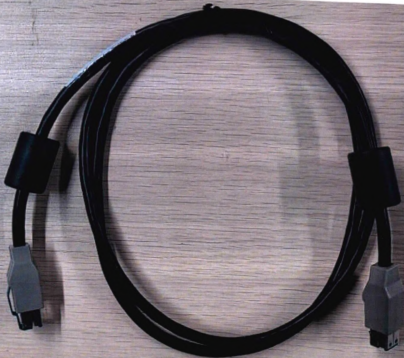
Кабель удлинительный для объединения двух док-станций. Вид сверху
