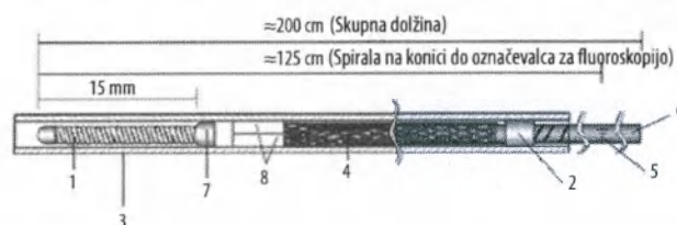
2. slika: Dovajalni sistem in vsadek pripomočka za embolizacijo Pipeline™ Vantage s tehnologijo Shield Technology™ (ni v merilu)
