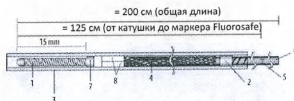
Рисунок 2. Изделие для эмболизации Pipeline Vantage с системой доставки Shield Technology и имплантатом (без масштабирования)
