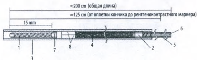
Рисунок 2. Система доставки и имплантат устройства для эмболизации Pipeline™ Vantage с технологией Shield Technology™ (масштаб не выдержан)
