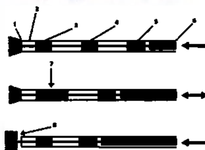
Фигура 2. Устройство за емболизация Pipeline™ Flex с Shield Technology™ (Схема на връщане в микро катетъра, наблюдавано под флуороскопски контрол; изобразението не е в мащаб).
