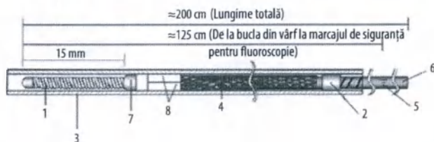
Figura 2. Sistemul de amplasare și implantul dispozitivului de embolizare Pipeline™ Vantage cu Shield Technology™ (reprezentarea nu este la scară)
