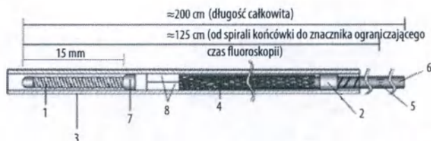
Rysunek 2. System wprowadzający i implant urządzenia do embolizacji Pipeline™ Vantage wyposażonego w technologię Shield Technology™ (nie zachowano skali)
