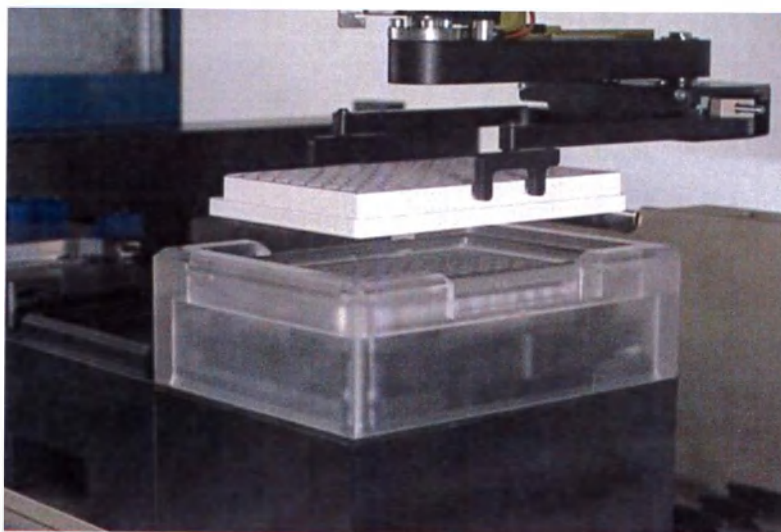
Роботизированная рука устройства для транспортировки планшетов iSWAP в процессе перемещения микропланшетов в CVS.
