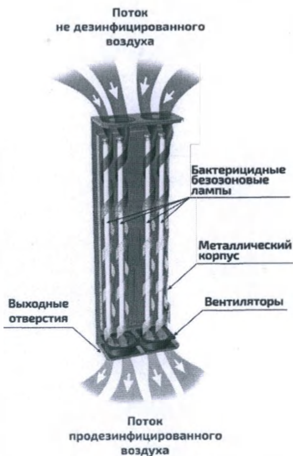
Рисунок 1 - Устройство рециркулятора
