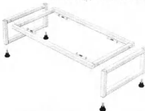
Рис.1-сборка каркаса: ЛК-600-СМС-В, ЛК-800-СМС-В, ЛК-1200-СМС-В-1, ЛК-1500-СМС-В-1, ЛК-1200-СМС-В-2, ЛК-1500-СМС-В-2
