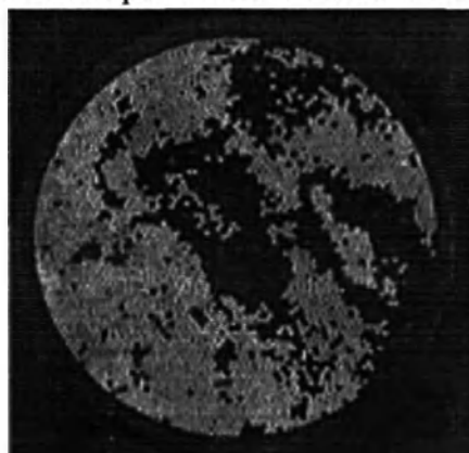
Рис. 2 Поврежденные оптические волокна
