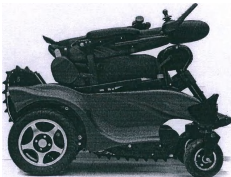
Рисунок 18 – Кресло-коляска со сложенной спинкой
