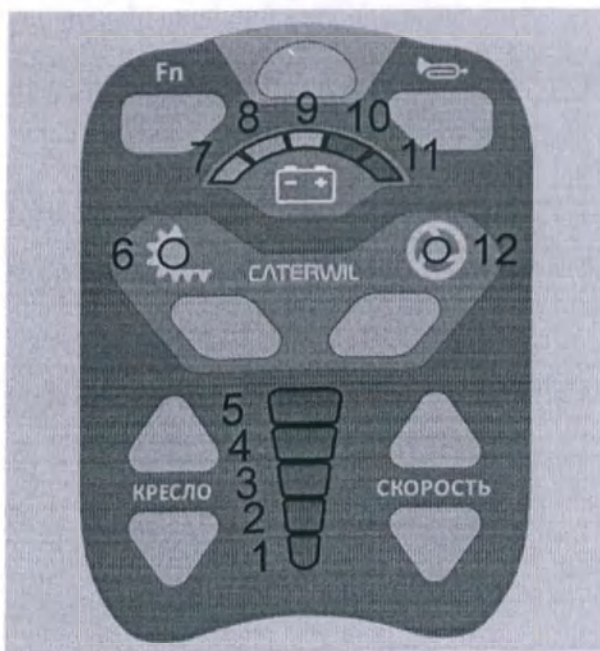
Рисунок 24 – Светодиоды на пульте управления
