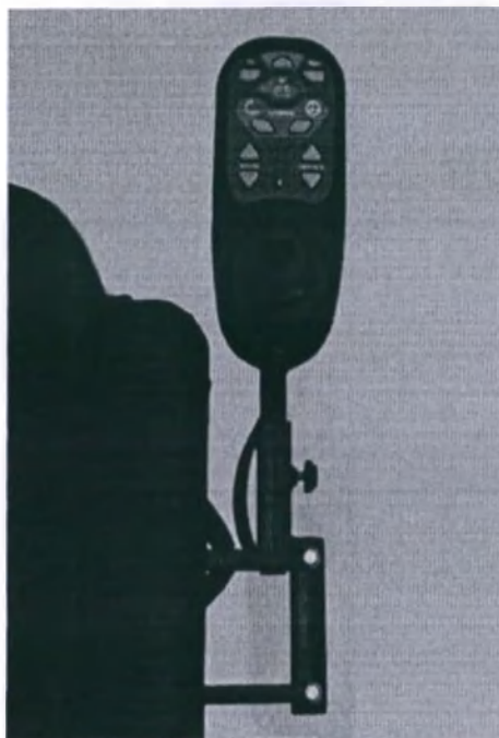
Рисунок 11 – Держатель пульта управления коляски
