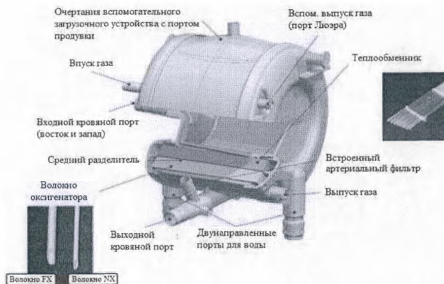
Рисунок 13.4 – Оксигенатор мембранный CAPIOX NX19 в разрезе
