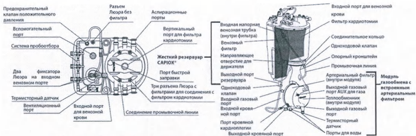
Рисунок 13.3 – Схематичное изображение оксигенатора мембранного CAPIOX NX19
