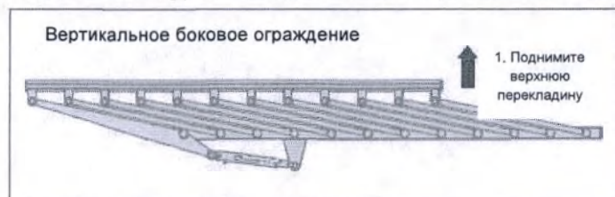
Рисунок 8. Боковое ограждение в сложенном положении
