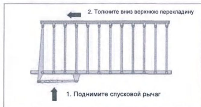
Рисунок 10. Боковое ограждение в поднятом положении
