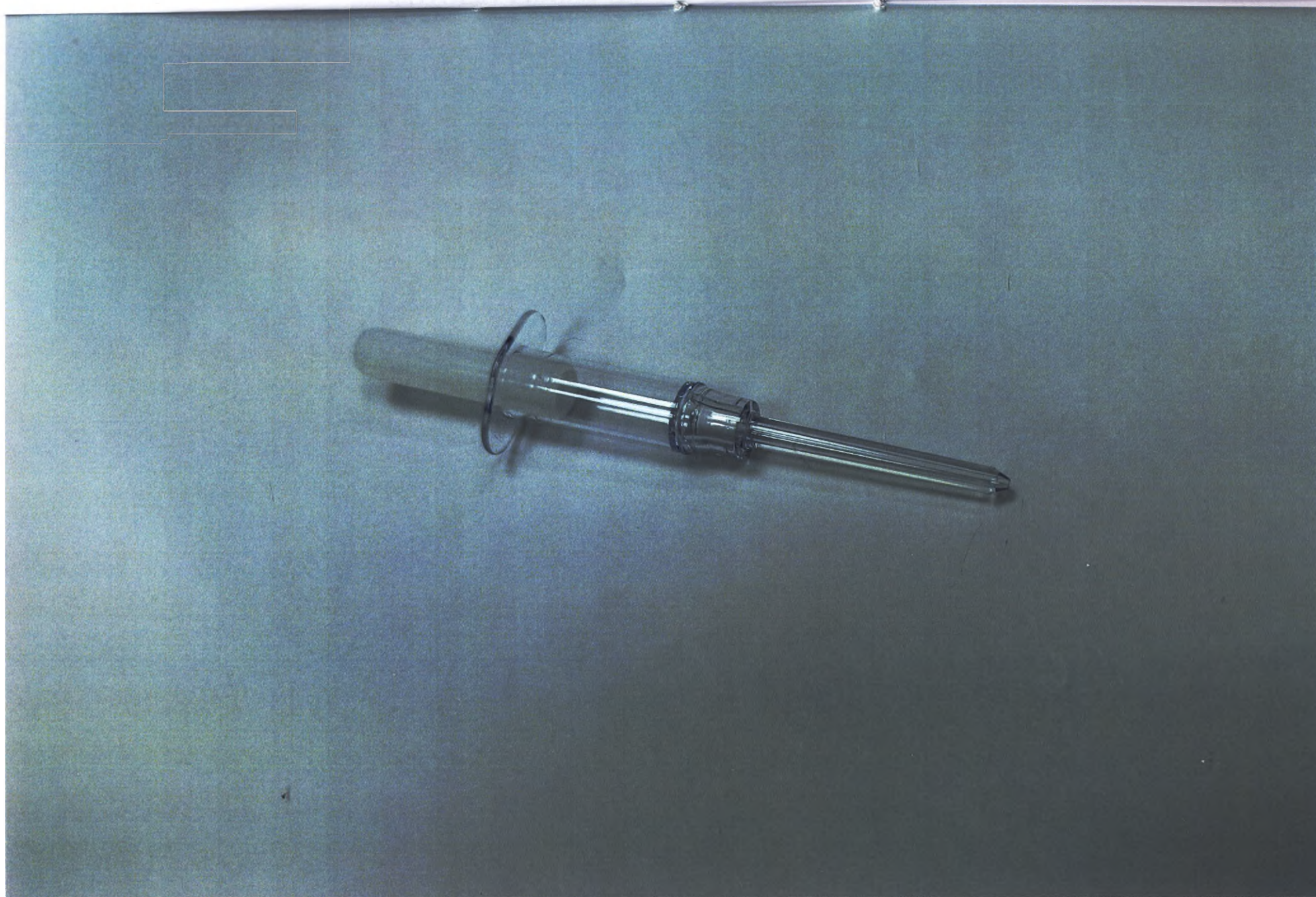
Рис 2. Устройство для исследования проб крови Minivette POCT 17.2111.020
