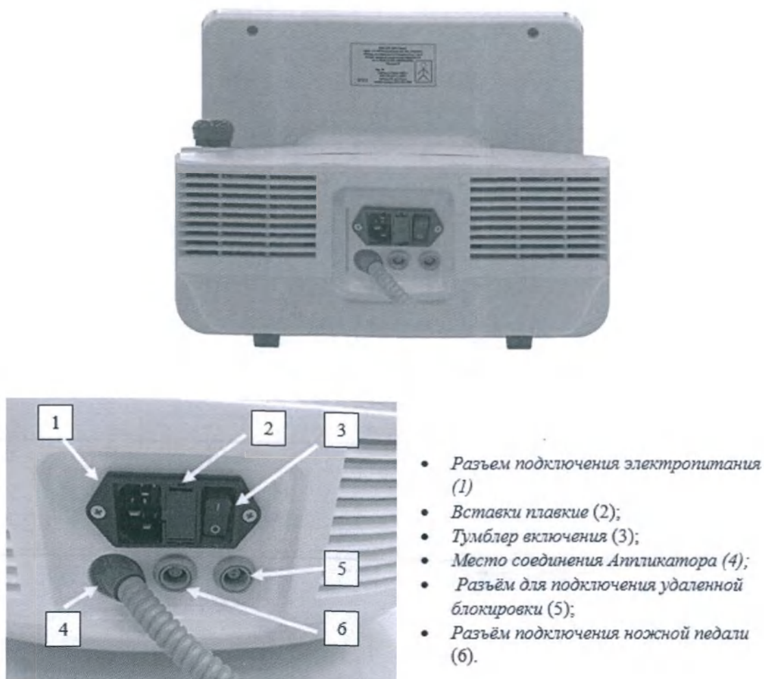
Рис. 4. Аппарат лазерный медицинский «FiberLase DG» по ТУ 26.60.13-062-18003536-2021 – Вид сзади, описание разъемов
