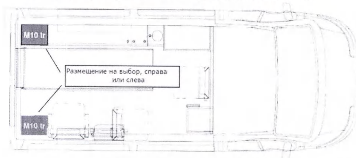
Рисунок 14 - Схема размещения КС МО2-10 TR (вид сверху)
