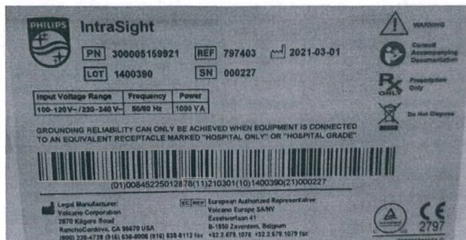
Рис. 9. Маркировка трансформатора гальванической развязки.
