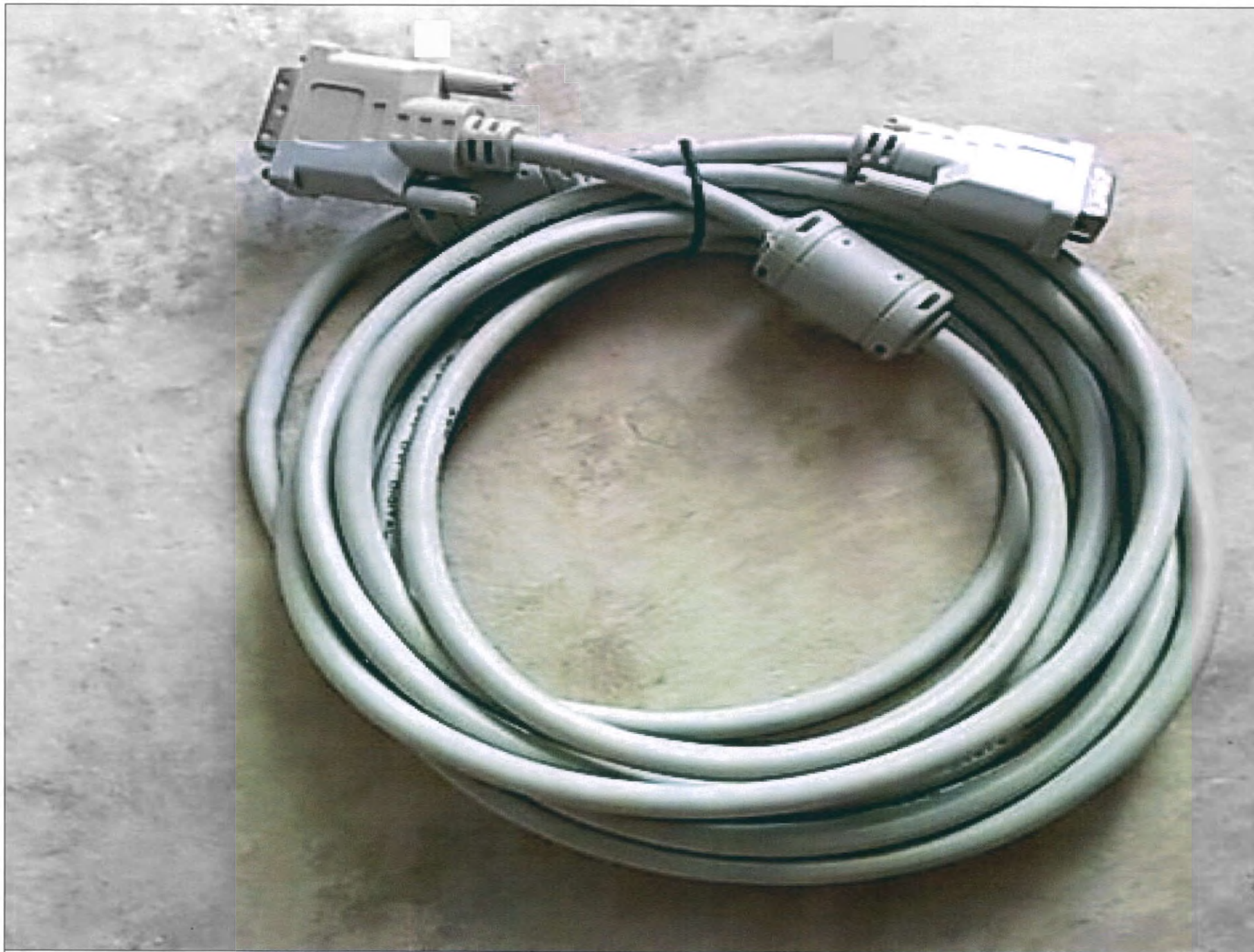
8.2 Кабели соединительные видеосигнала DVI, VGA, HDMI. Кабель соединительный DVI-D.
