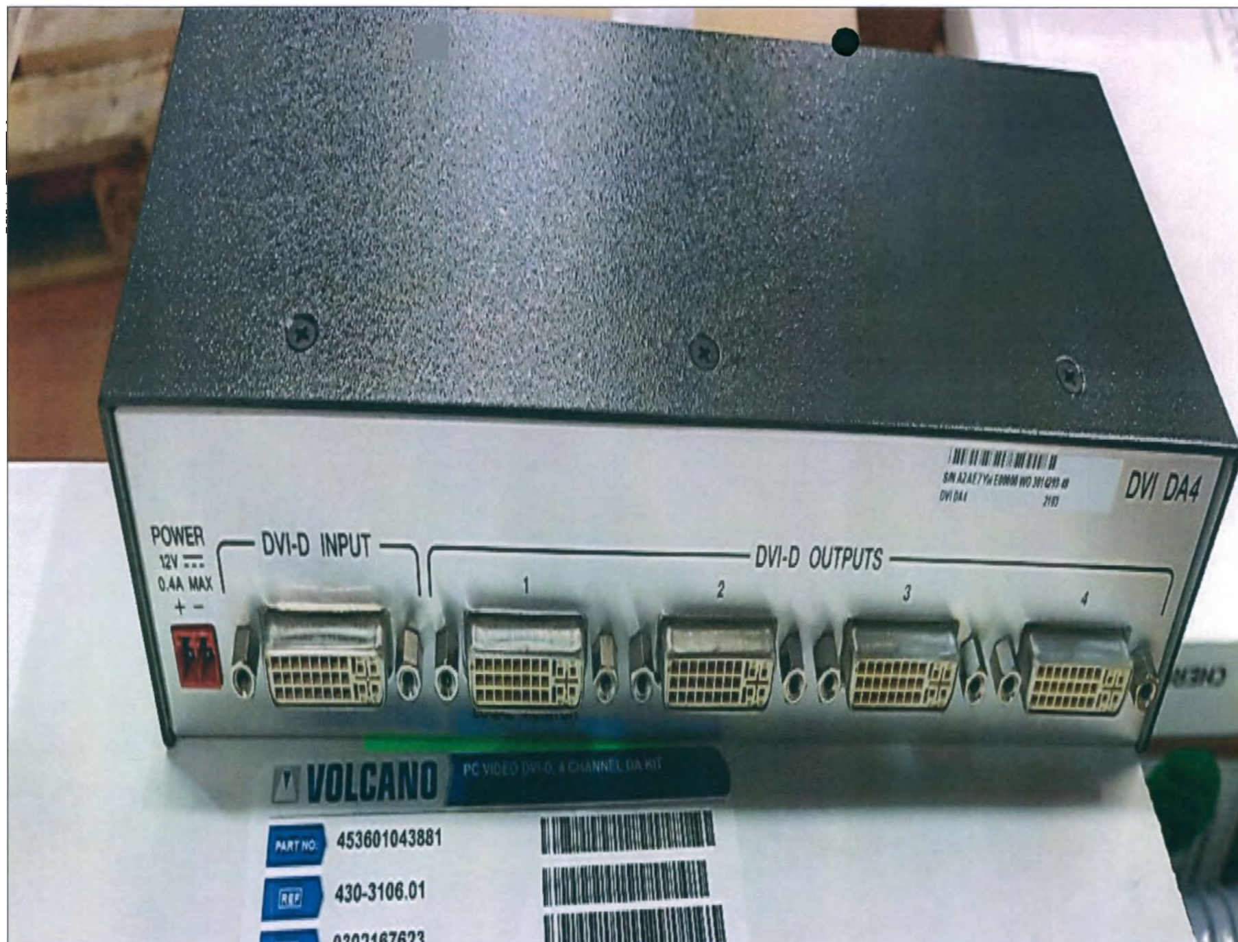
6.4 Видеоусилитель 2-х и/или 4-х канальный, не более 2 шт. Усилитель-распределитель с одним входом и четырьмя выходами DVI-D.
