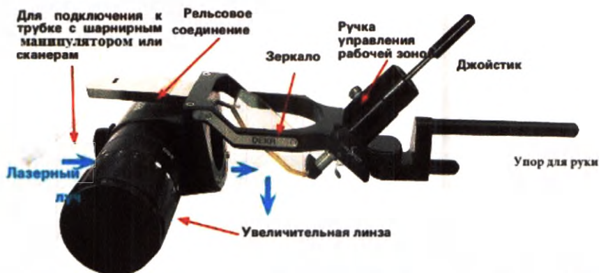
Рисунок 137. Основные части микроманипулятора EasySpot Hybrid
