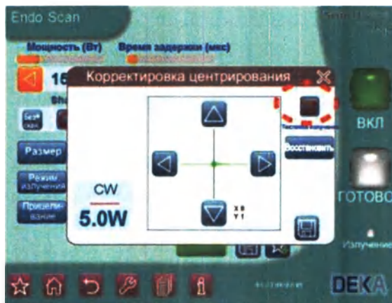
Рисунок 101. Исправление центрирования EndoScan
