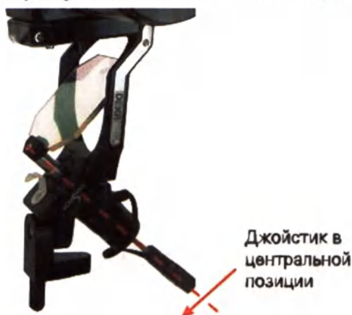
Рисунок 134. Центрирование лазерного луча на финальном зеркале
