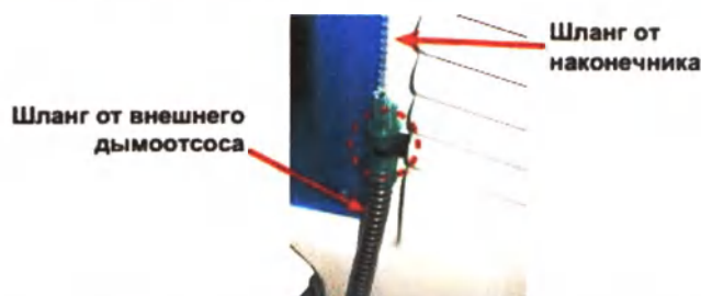
Рисунок 16. Положение шланга от дымоотсоса на оборудовании
