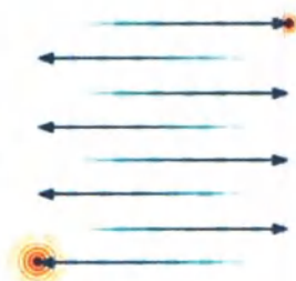
Рисунок 85. Пример режима сканирования Normal
