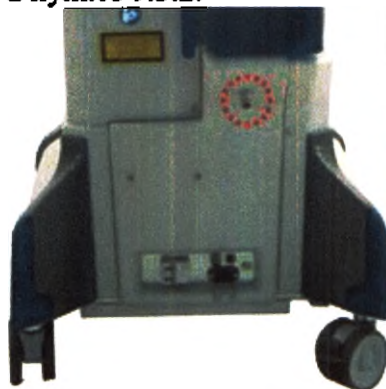
Рисунок 35. Подключение разъёма воздушного потока к системе
