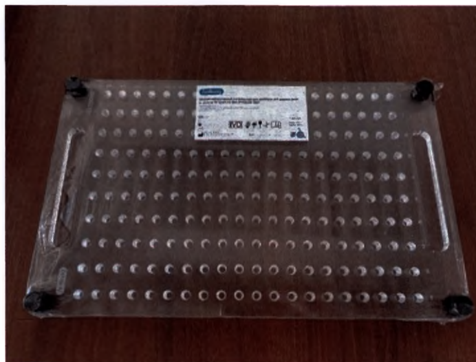
Рисунок 6. Штатив RA-20005 для микропробирок 0,5 мл, 200 лунок
