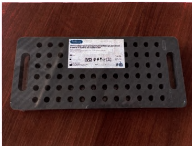
Рисунок 15. Штатив RA-7215-PVC для микропробирок 1,5 мл, 72 лунки, химически устойчивый
