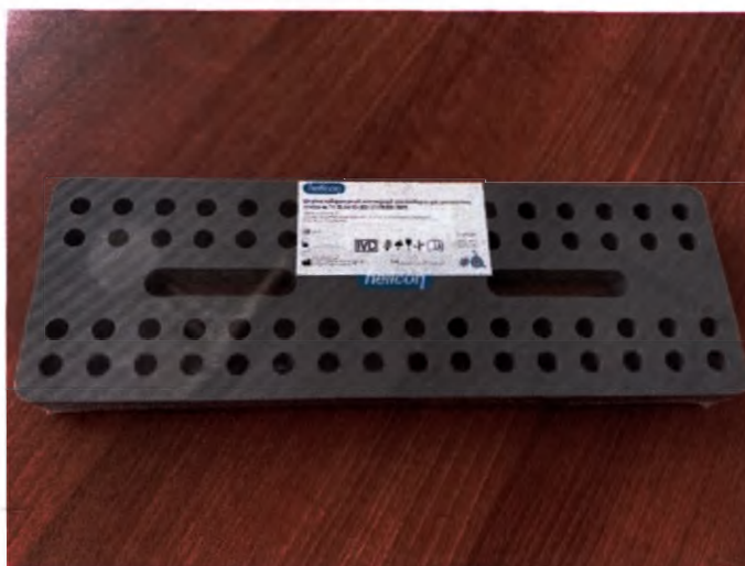
Рисунок 12. Штатив RA-6420-PVC для микропробирок 1,5-2,0 мл, 64 лунки, химически устойчивый
