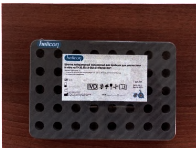
Рисунок 13. Штатив RA-4020-PVC для микропробирок 1,5-2,0 мл, 40 лунок, химически устойчивый
