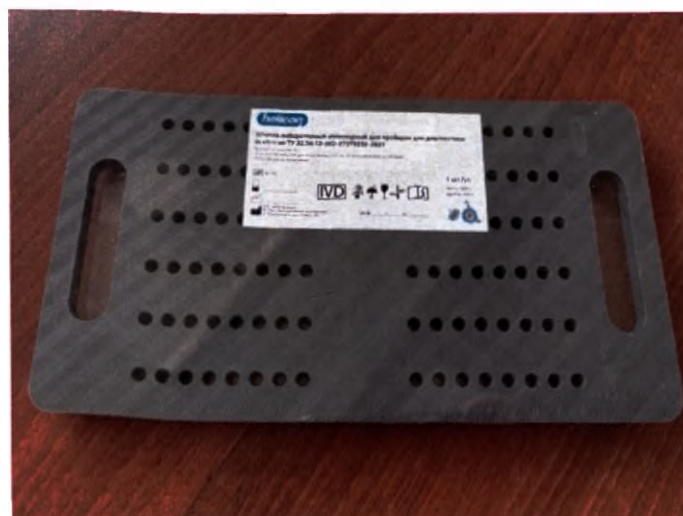
Рисунок 14. Штатив RA-9602-PVC для стрипованных микропробирок 0,2 мл., 96 лунок, химически устойчивый
