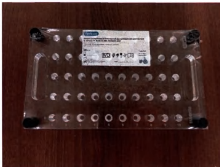
Рисунок 9. Штатив RBA-5015 для микропробирок 1,5 мл, 50 лунок, удлиненный
