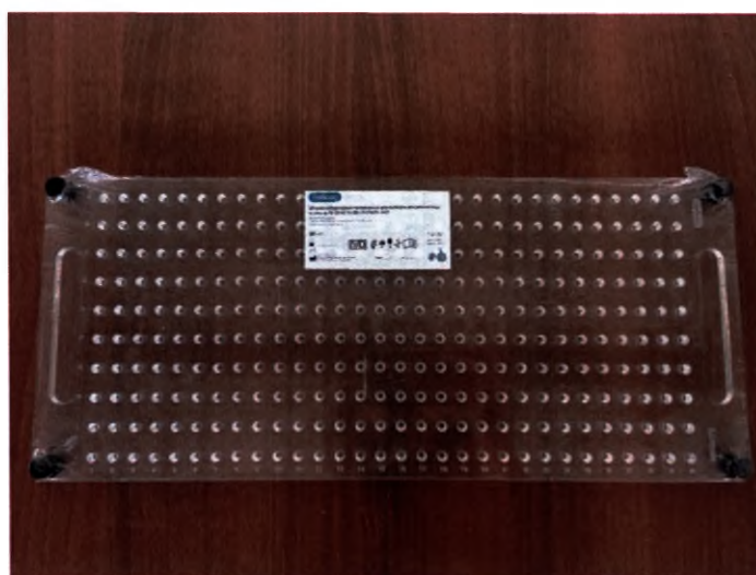
Рисунок 5. Штатив RA-30005 для микропробирок 0,5 мл, 300 лунок
