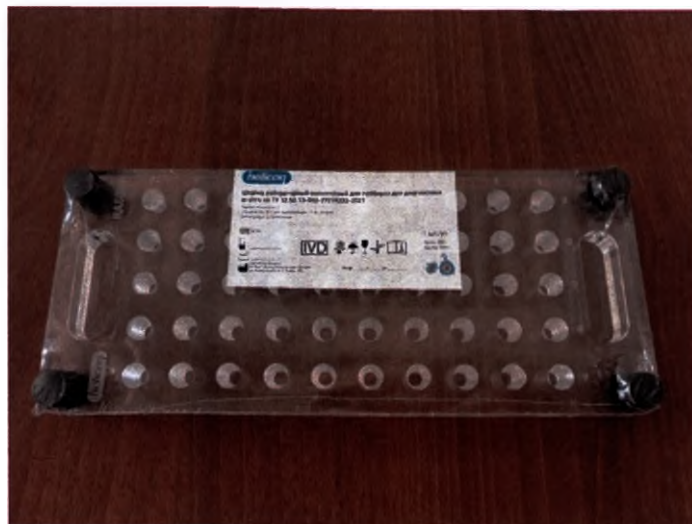
Рисунок 3. Штатив RA-5015 для микропробирок 1,5 мл, 50 лунок
