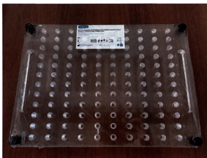
Рисунок 11. Штатив RBA-12015 для микропробирок 1,5 мл, 120 лунок, удлиненный
