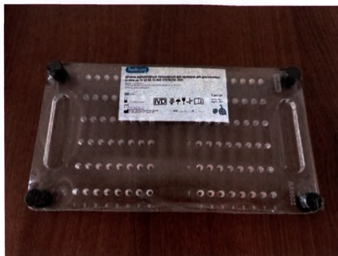
Рисунок 1. Штатив RA-9602 для стрипованных микропробирок 0,2 мл, 96 лунок
