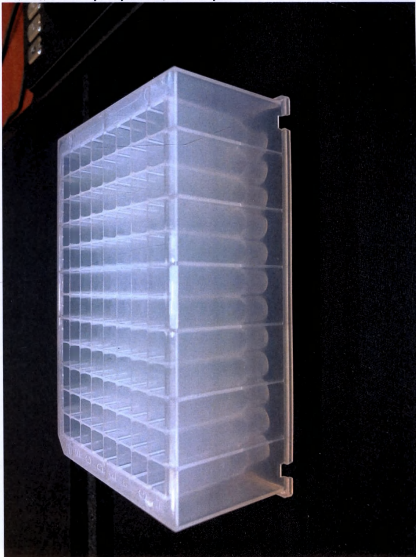
Общий вид планшета глубоколоночного 2,2 мл. на 96 лунок
