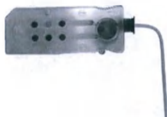
Рис. 1-18 Трубка для аспирации образца
