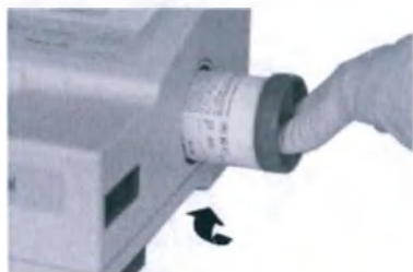
Рис.2-8 Установка газового баллона
