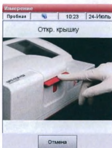
Рис.5-6 Откройте крышку измерительной камеры
