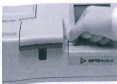
Рис.5-14 Прикрепите пробоотборную трубку
