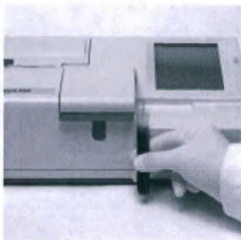
Рис. 5-16 Разместите пробирку с пробой
