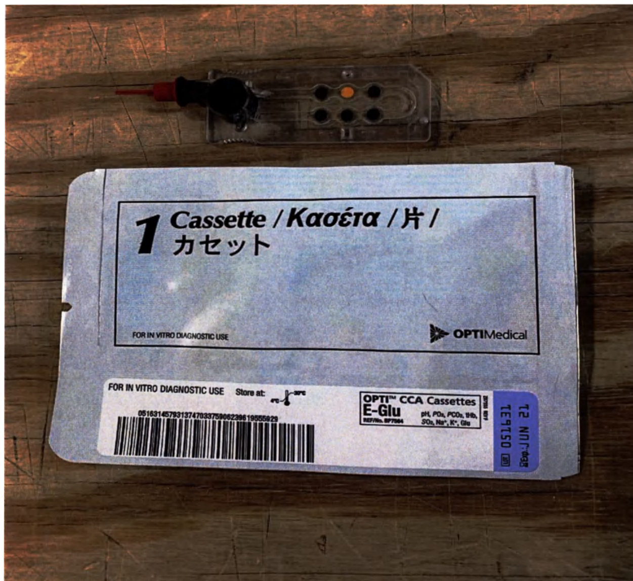
Измерительные кассеты типа E-Glu (кассета и ее индивидуальная упаковка)
