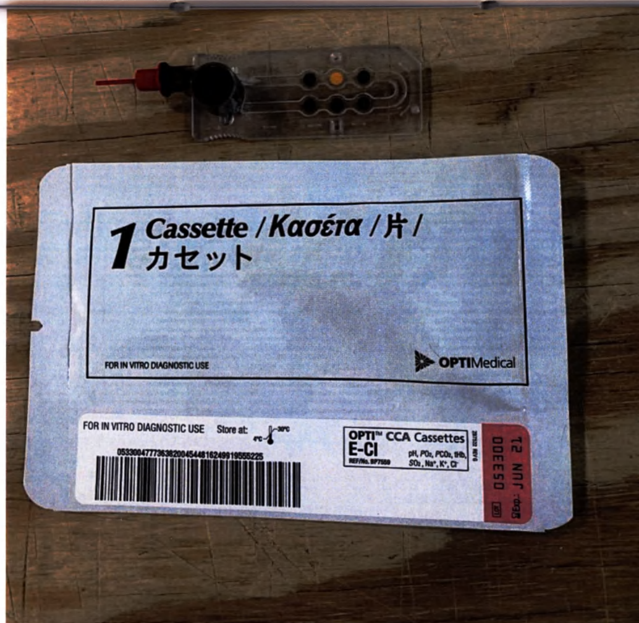
Измерительные кассеты типа E-CI (кассета и ее индивидуальная упаковка)
