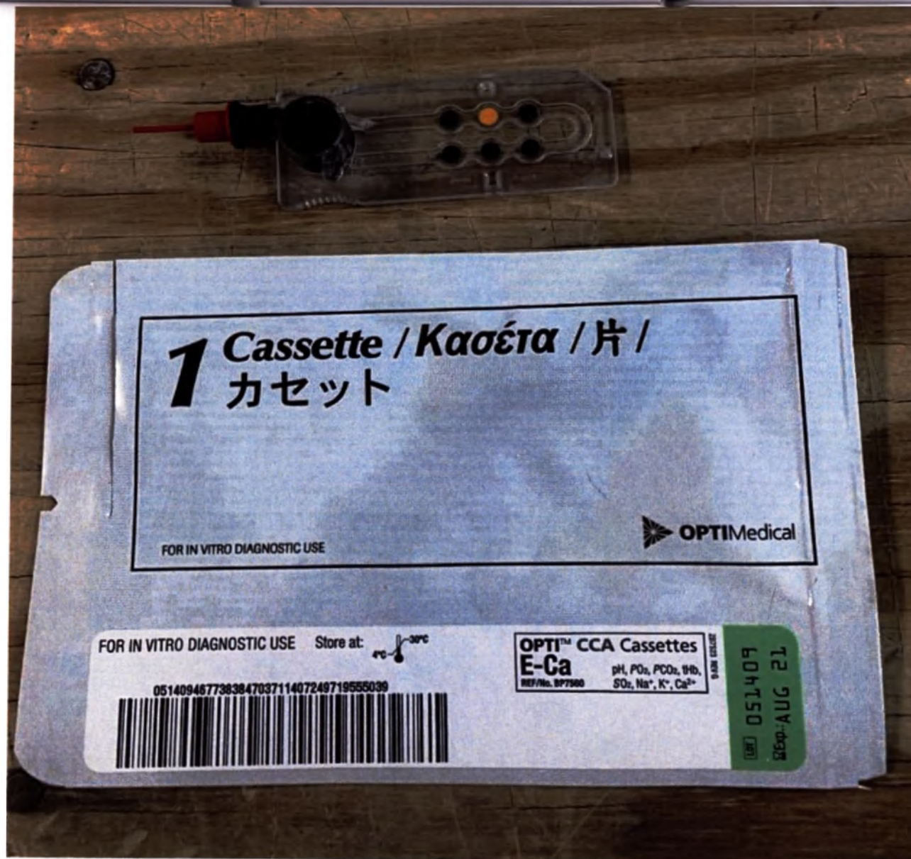
Измерительные кассеты типа E-Ca (кассета и ее индивидуальная упаковка)
