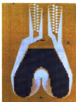
Матричная структура электропроводящего сенсора
