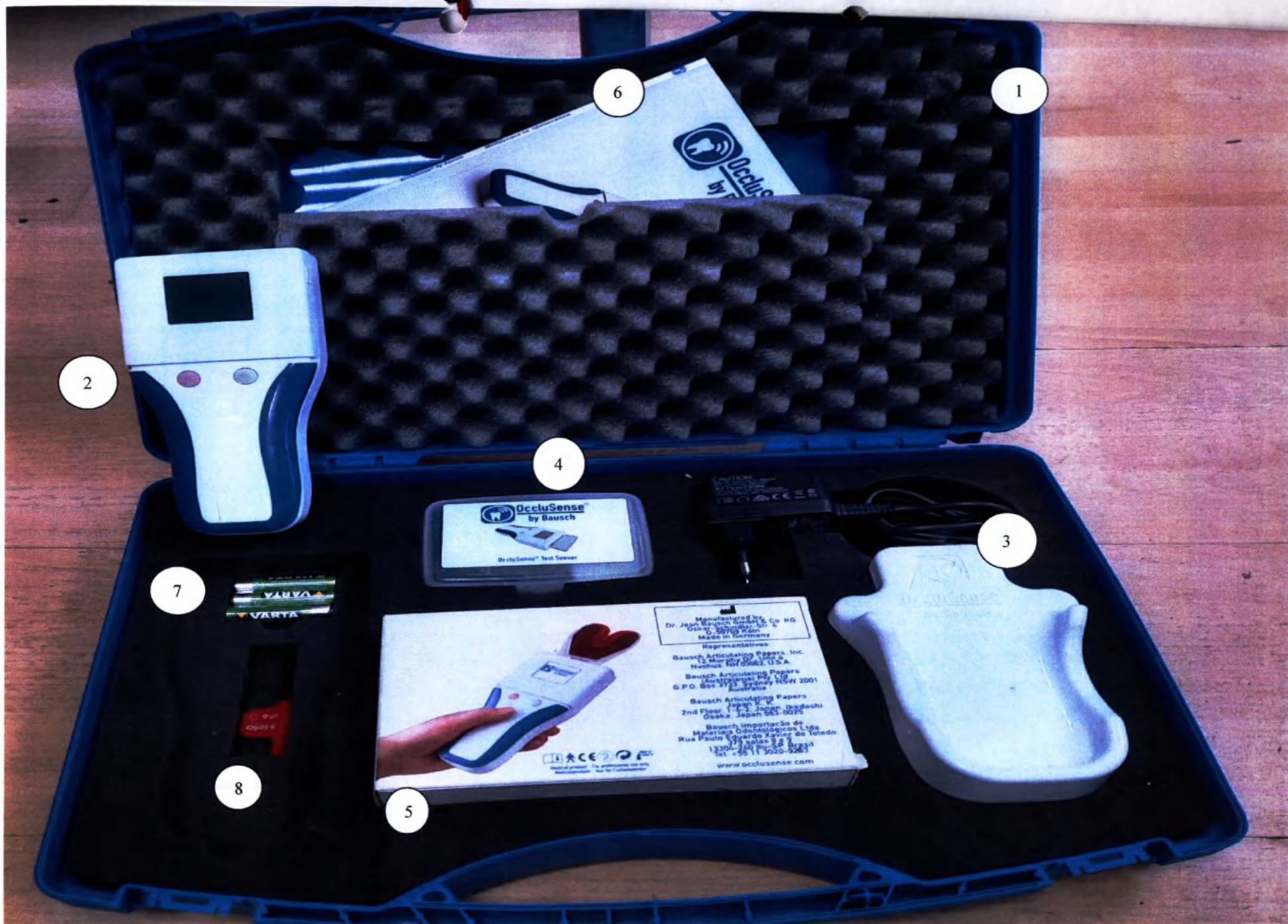
Фото 8. Совместимое медицинское изделие Система OccluSense в составе: 1 – Кейс для хранения, 2 - Регистратор ВК 5001, 3 - Зарядная станция ВК 5002, 4 - Тестовый датчик, 5 - Аккумулятор (NiMH) – 3 шт., 6 - Инструкция по применению ВК 5060, 7 - Аккумулятор (NiMH) – 3 шт., 8 - Отвертка IP 6.
