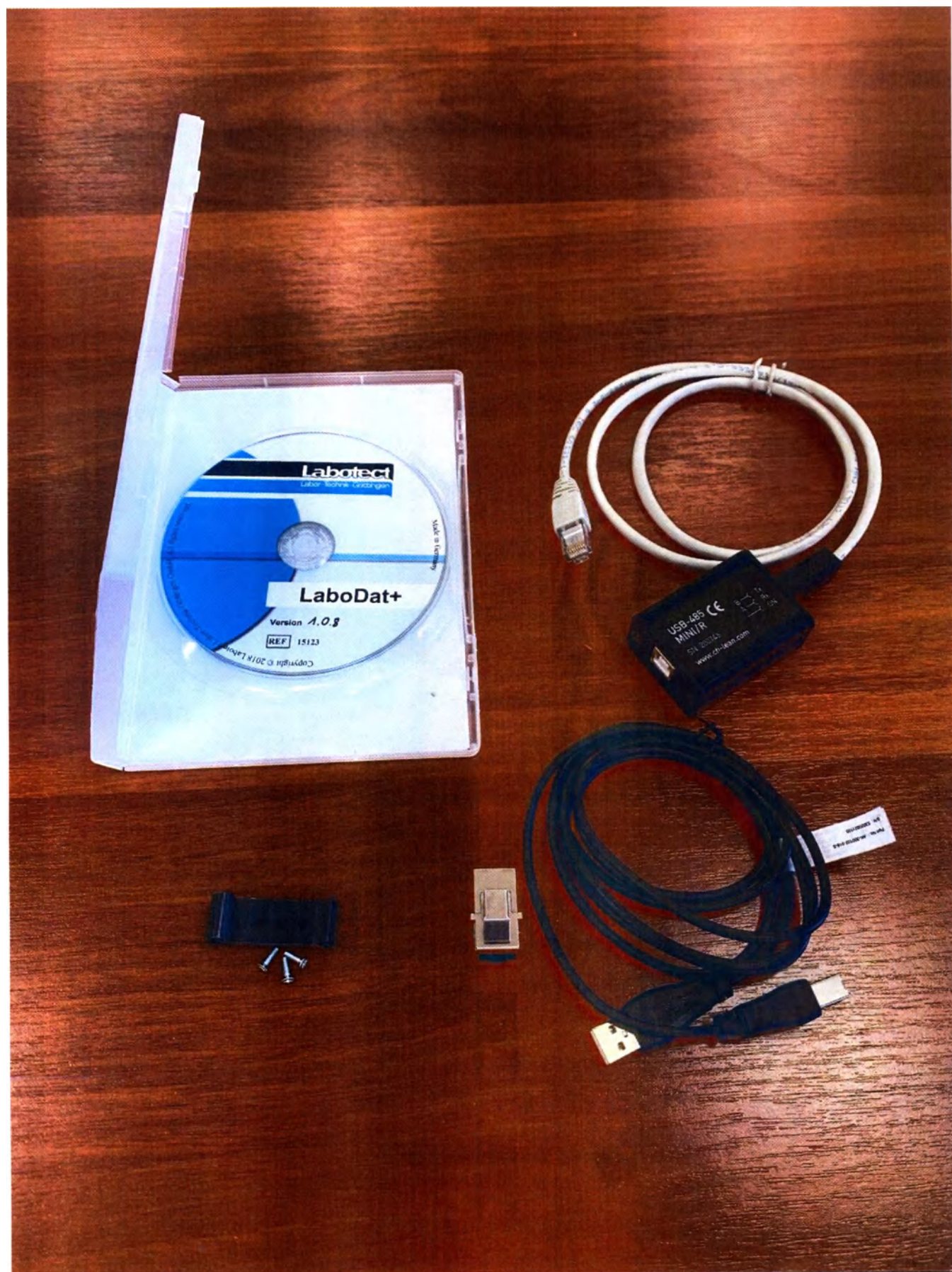
Фото 8. Программное обеспечение LaboDat+ для ПК (в составе: CD-диск с ПО, преобразователь интерфейсов USB-RS485, адаптер проходной RJ45, USB-кабель, LAN-кабель, крепеж для кабеля)
