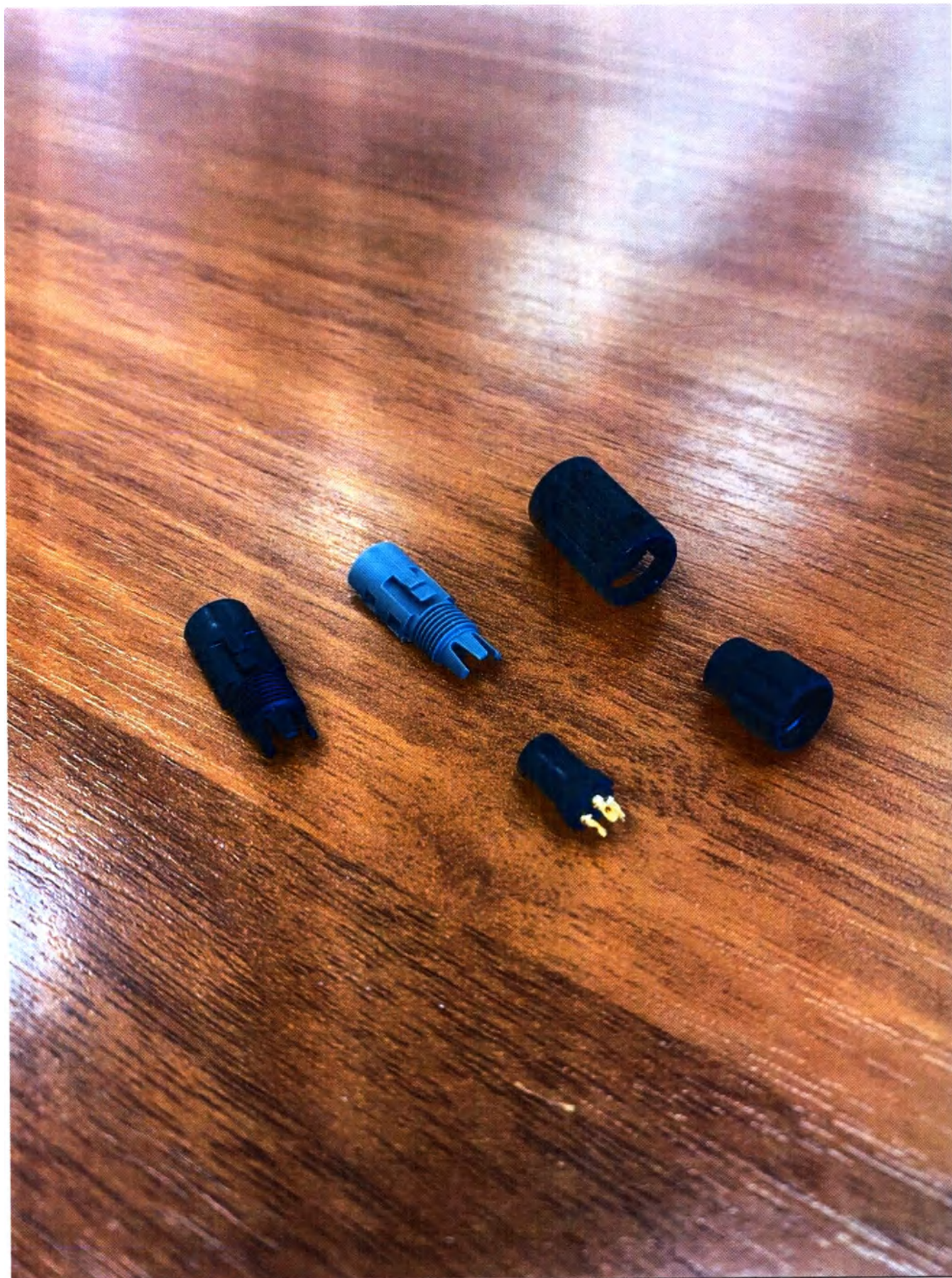
Фото 7. Коннектор для сигнализации внешней
