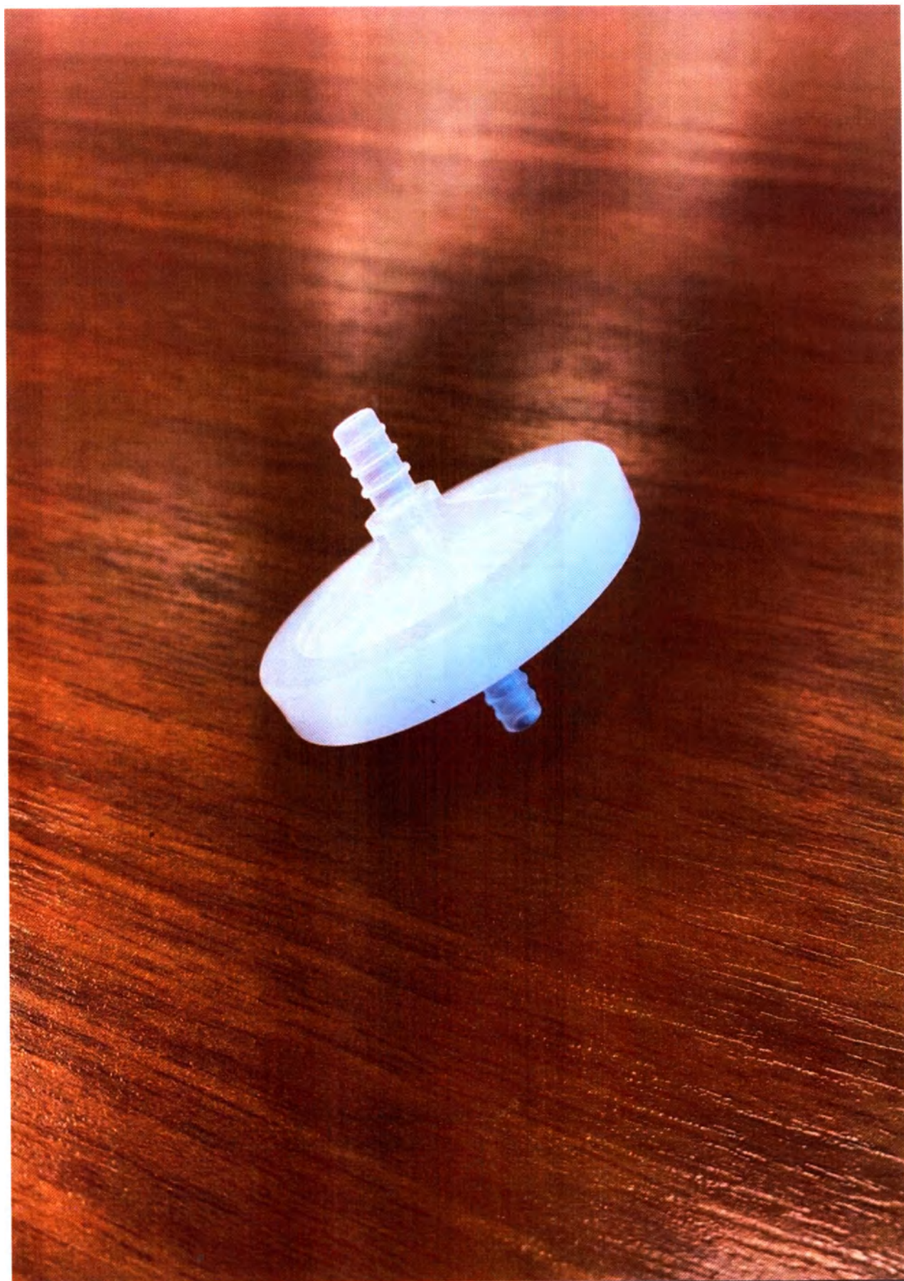
Фото 4. Фильтр внутренний, 37 мм
