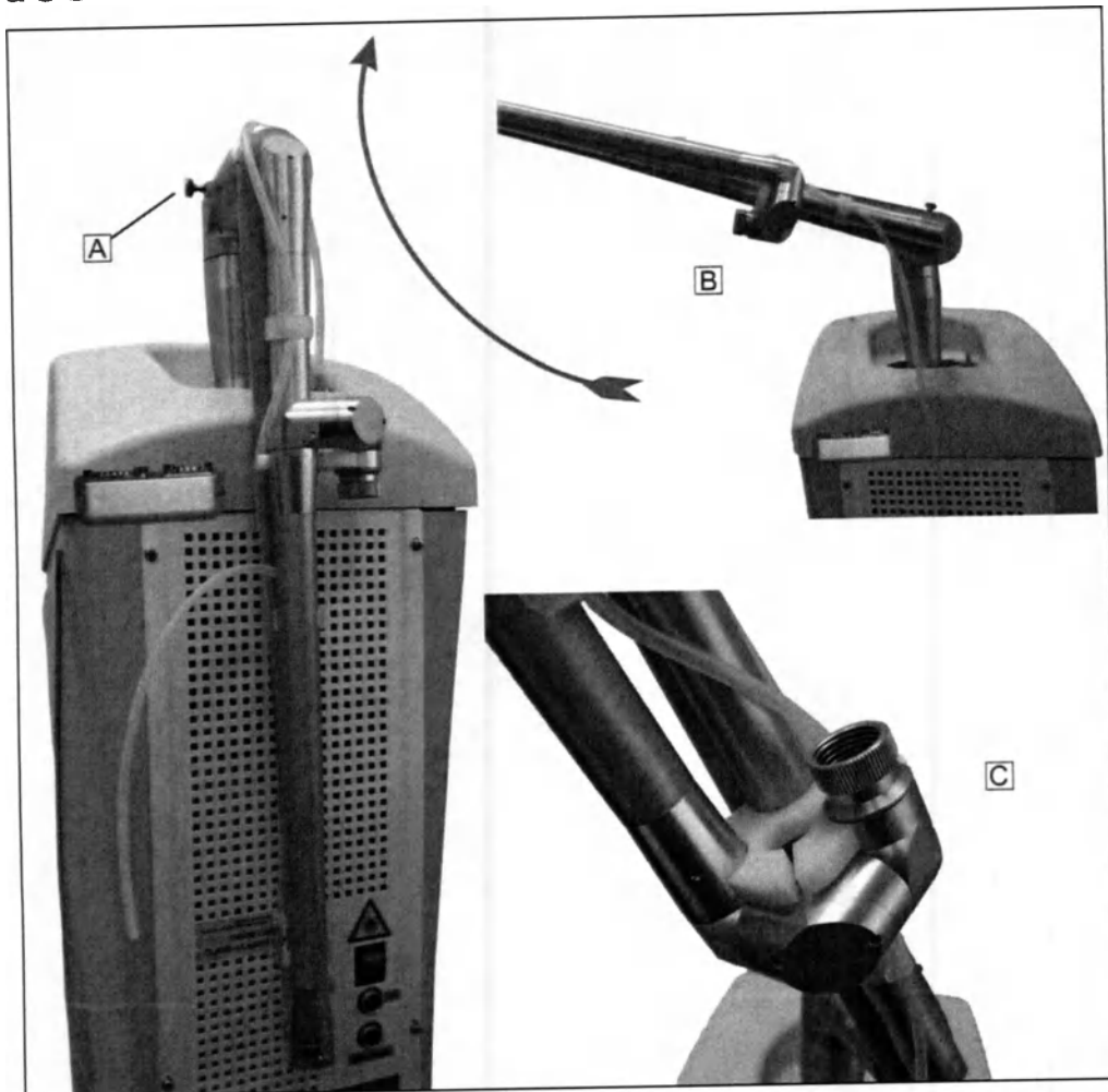
Рисунок 20-1-1: Высвобождение шарнирного кронштейна
