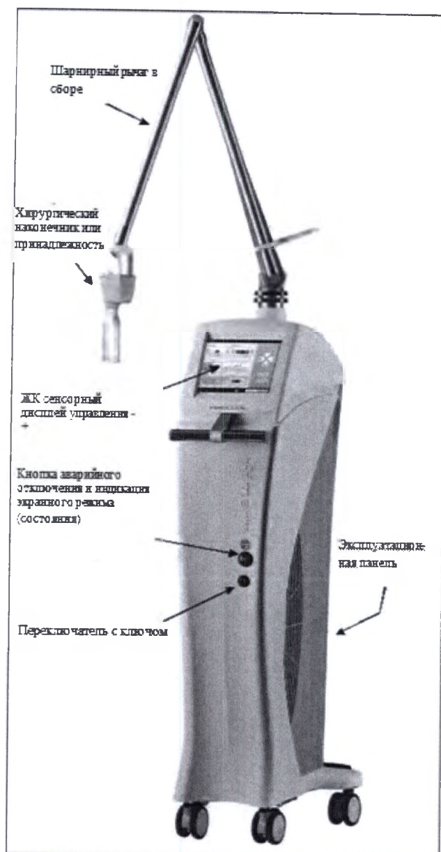
Рисунок 12-2-1: Основные компоненты Аппарата
